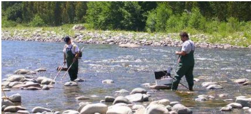
**Figura 7.15:** Muestreo con pesca eléctrica. Río Huequecura, sector Alto Bío Bío. (Fuente: elaboración propia).
