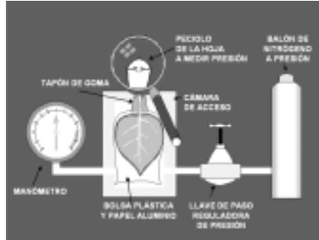
**Figura 6.** Esquema de bomba de presión tipo Scholander.
