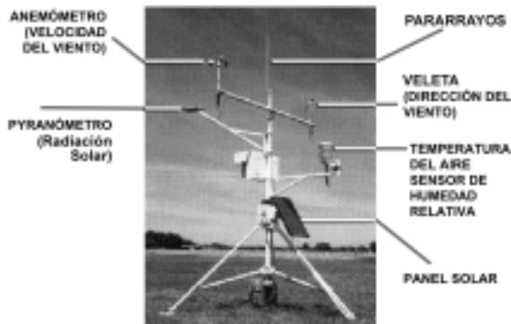
**Figura 1.** Estación microclimática.
