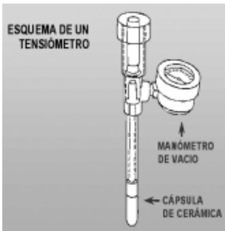
**Figura 4.** Tensiómetro con manómetro de vacío o vacuómetro.
