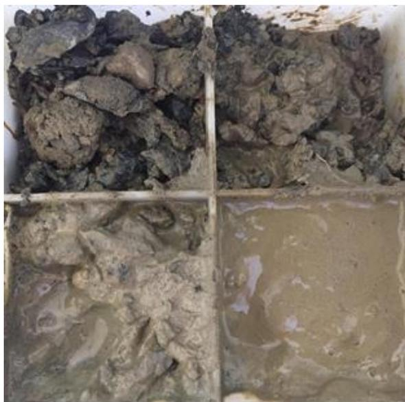
Figura 7.37 Muestra en Puerto Natales entre los 4 y 6 metros de profundidad. Fuente: Elaboración propia.
