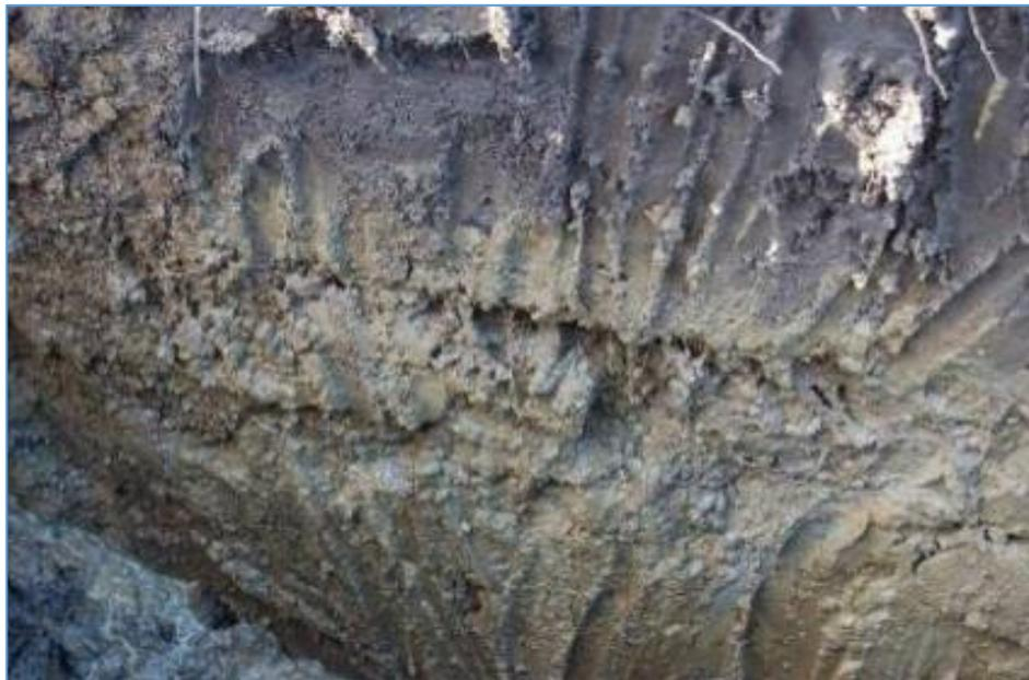
*Figura 2.43: Calicata 2, estrato de gravillas en matriz de arcillas bajo el suelo vegetal. Fuente: Ingeniería Alemana S.A., 2008.*
