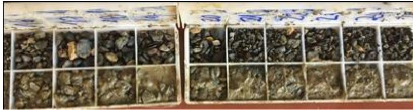
Figura 7.40 Muestra en Puerto Natales entre los 16 y 26 metros de profundidad. Fuente: Elaboración propia.
