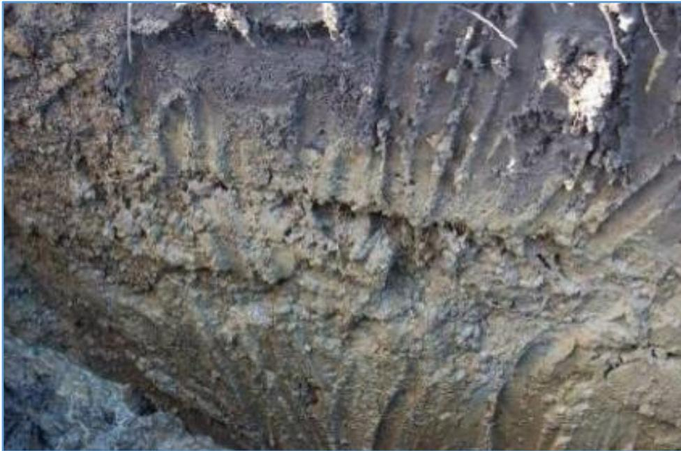
Figura 7.24: Calicata 2, estrato de gravillas en matriz de arcillas bajo el suelo vegetal. Fuente: Ingeniería Alemana S.A., 2008.
