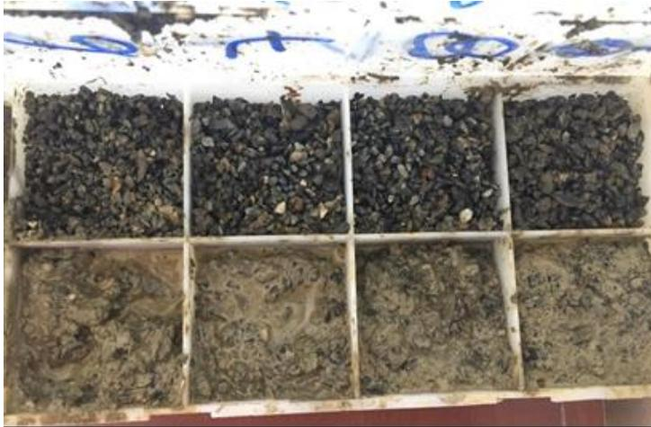
*Figura 7.38 Muestra en Puerto Natales entre los 6 y 10 metros de profundidad. Fuente: Elaboración propia.*
