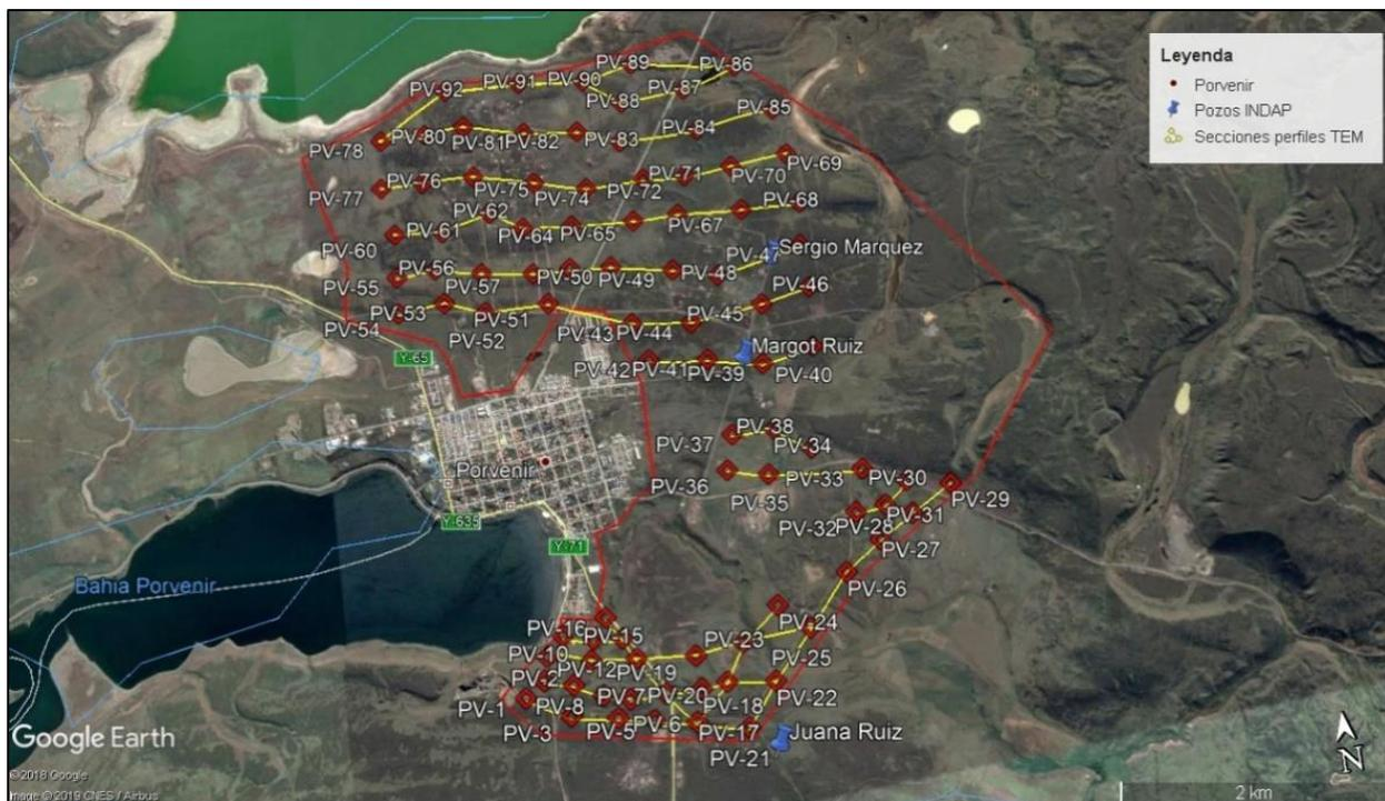
Figura 7.20: Mapa de ubicación pozos INDAP y secciones de perfiles TEM. Fuente: Elaboración propia.
