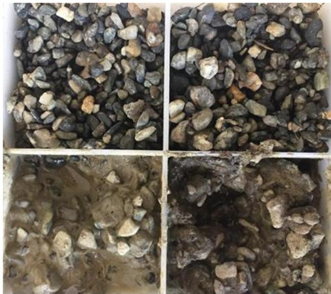
Figura 7.31 Muestras de Porvenir entre los 3 y 5 metros de profundidad. Fuente: Elaboración propia.
