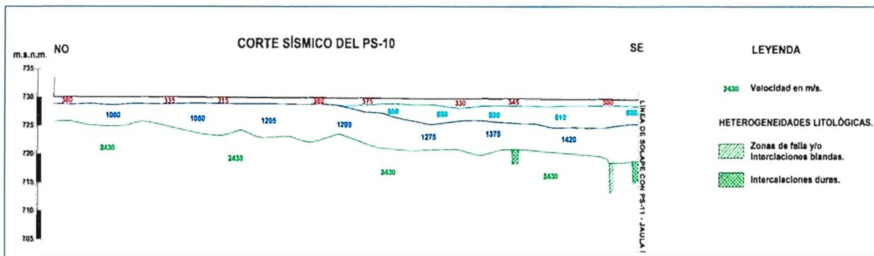
El perfil de sismica de refracción PS-10 de 120 m de longitud, se ubicó en el pie de la margen derecha, paralelo al cauce fluvial y transversal al eje Jaula 1.
