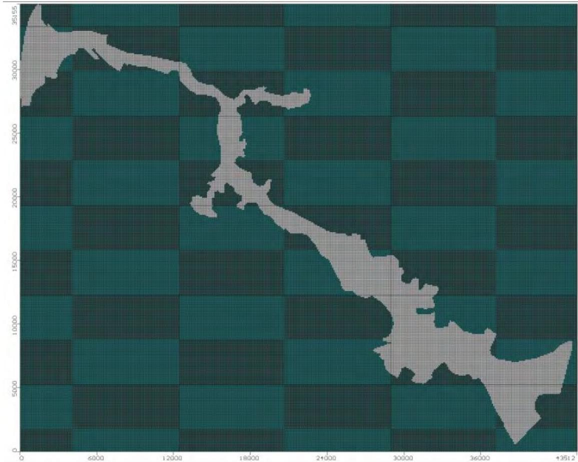
Figura 70. Mallado y celdas activas del modelo
