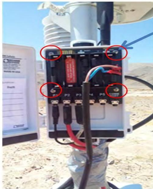
Tornillos a remover para recambio de chip Entel
