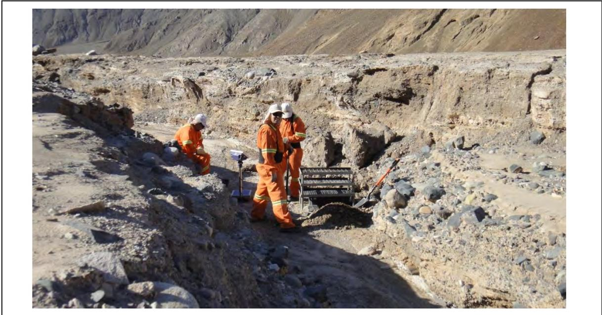
Figura 4.4 Vista del equipo trabajando en el levantamiento de las calicatas.
