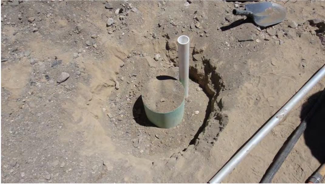
Figura 3.9 Vista del lisímetro antes de ser completamente cubierto por tierra.
