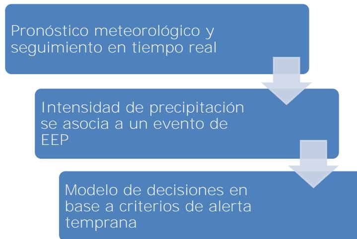
Figura 2.2 Esquema de funcionamiento del sistema de alerta temprana.
