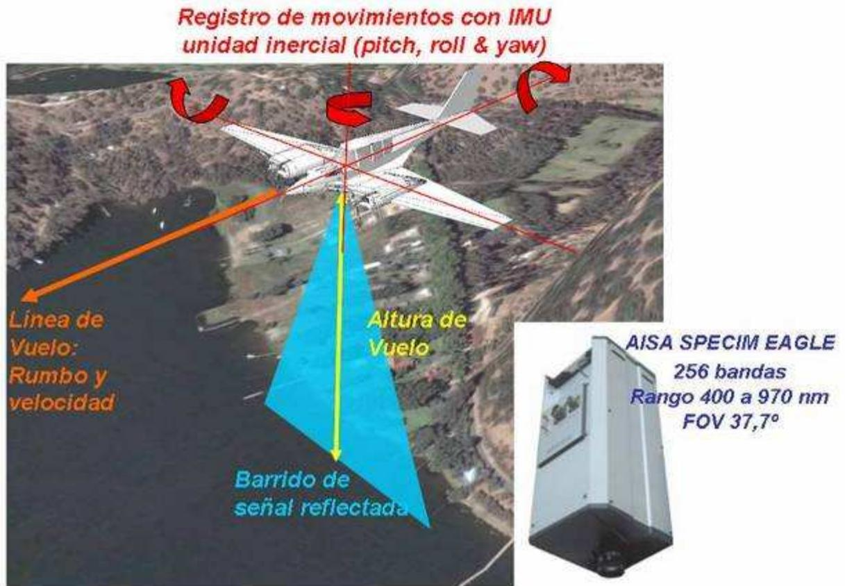
**Figura 3.6.** Diagrama de la obtención de reflectancia con el sensor hiperespectral AISA Eagle Specim. Se muestran los parámetros de programación de la adquisición de datos como la línea, velocidad y altura de vuelo, como también los parámetros de movimiento que registra la unidad de movimiento inercial (IMU) que permite efectuar la posterior rectificación espacial.
