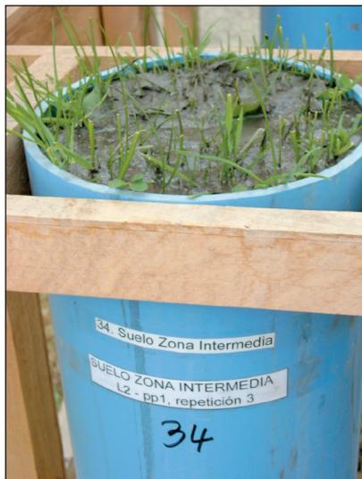
FIGURA 7.4. Lisímetro con lodo aplicado en cobertera.
