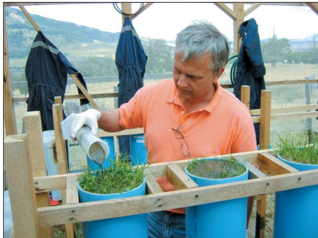
FIGURA 7.3. Aplicación de lodos en los lisímetros.
