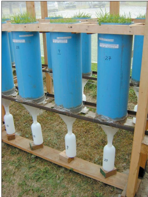
FIGURA 7.1. Lisímetros instalados en su unidad.
