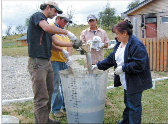
FIGURA 7.2. Dosificación del lodo para ser aplicado en lisímetros, según tratamiento.
