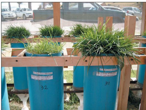
FIGURA 6. Lisímetros con praderas en crecimiento. Efectos de dosis de lodos.
