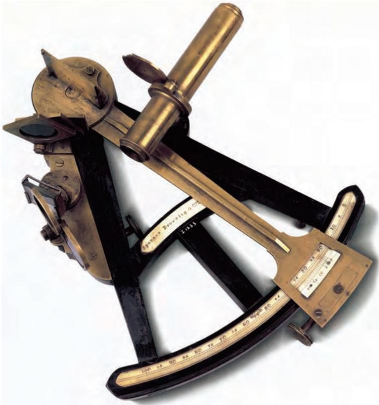
Sextante, instrumento que permite medir ángulos entre dos objetos, durante siglos fue de gran utilidad para la navegación marítima. En cartografía se utilizó para fijar la posición de un lugar (latitud), conociendo el ángulo formado entre el horizonte y un astro (Sol o estrella) y la hora.
