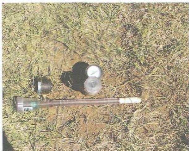
Foto 7.3. Tensiómetro: instrumento que permite determinar cuándo regar.
