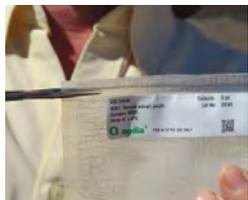
**Paso 2:** Corte el borde superior de la bolsa de extracción a lo largo de la etiqueta por sobre la línea de autosellado.
