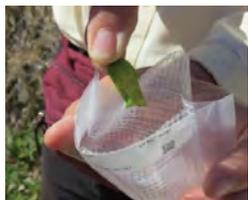
**Paso 3:** Inserte la muestra vegetal entre la malla presente en la parte interna de la bolsa de extracción de muestras.
