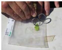
**Paso 4:** Con un objeto sólido sin punta, como por ejemplo una tapa de lápiz, por la parte externa de la bolsa de extracción, macere el tejido vegetal para que entre en contacto con la solución tampón. Macere hasta que se forme una solución homogénea color marrón claro. Deje reposar la muestra por 3 minutos en lugar sombreado.
