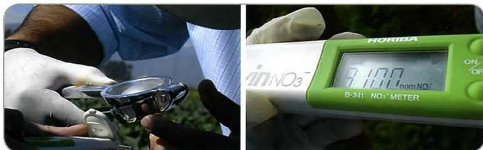
Foto 21. Extracción de savia y medidor de nitratos a nivel de campo.
