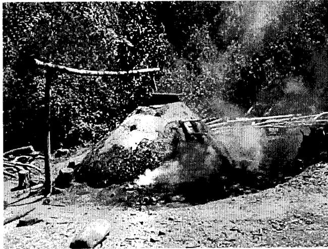
FIGURA N°6: IMAGEN DE UN HORNO EN PROCESO DE ELABORACIÓN DE CARBÓN
