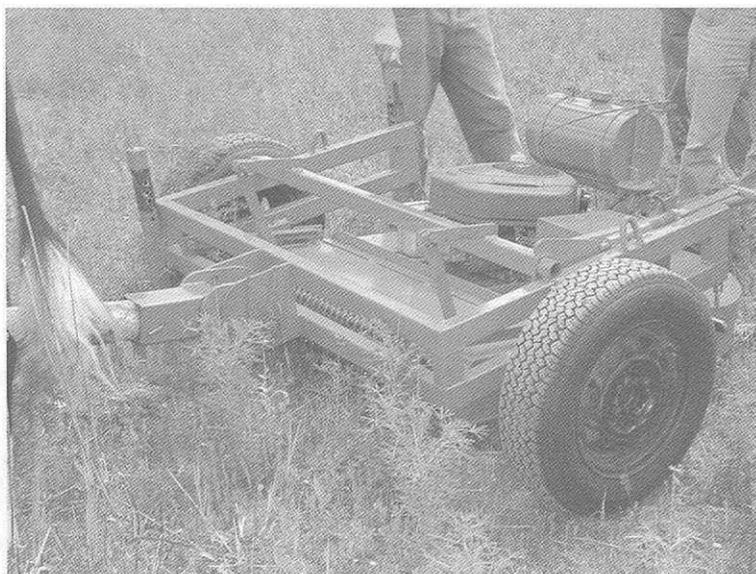
Figura 9. Desbrozadora rotativa con motor y traccionada por bueyes
