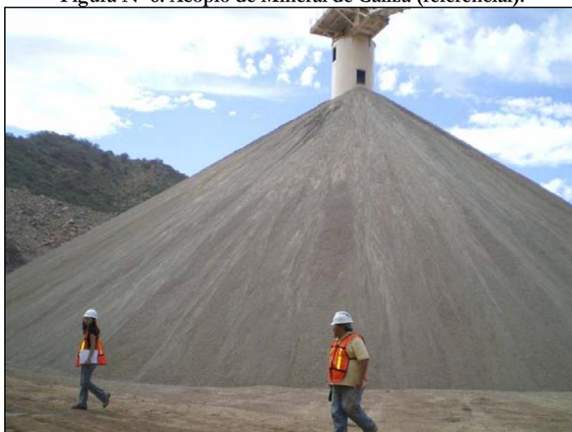
La caliza proveniente del acopio de mineral, antes de ingresar a los molinos de bolas (2 equipos), pasará por un harnero scalper que separará los finos. El grueso, el agua de elaboración y el flujo inferior (“underflow”) de la batería de ciclones se mezclarán e ingresarán a cada molino.
