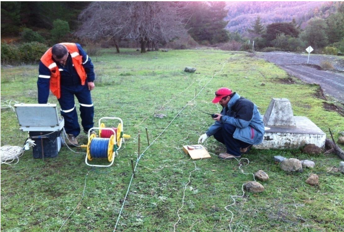
*Foto 6. Toma de datos de terreno en SEV 12, lado sur de río.*
