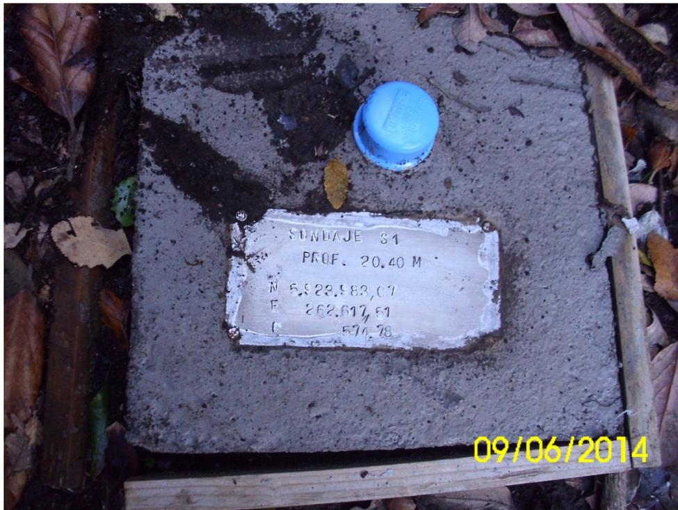
**Fotografía N°2 Monolito Sondaje S-1**
