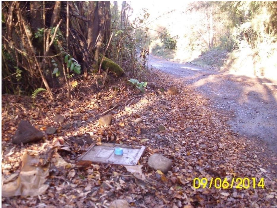
En el sondaje S – 2 ubicado en la rivera sur del río, no fue posible realizar la construcción de un monolito ya que este está ubicado en la orilla del camino público.
