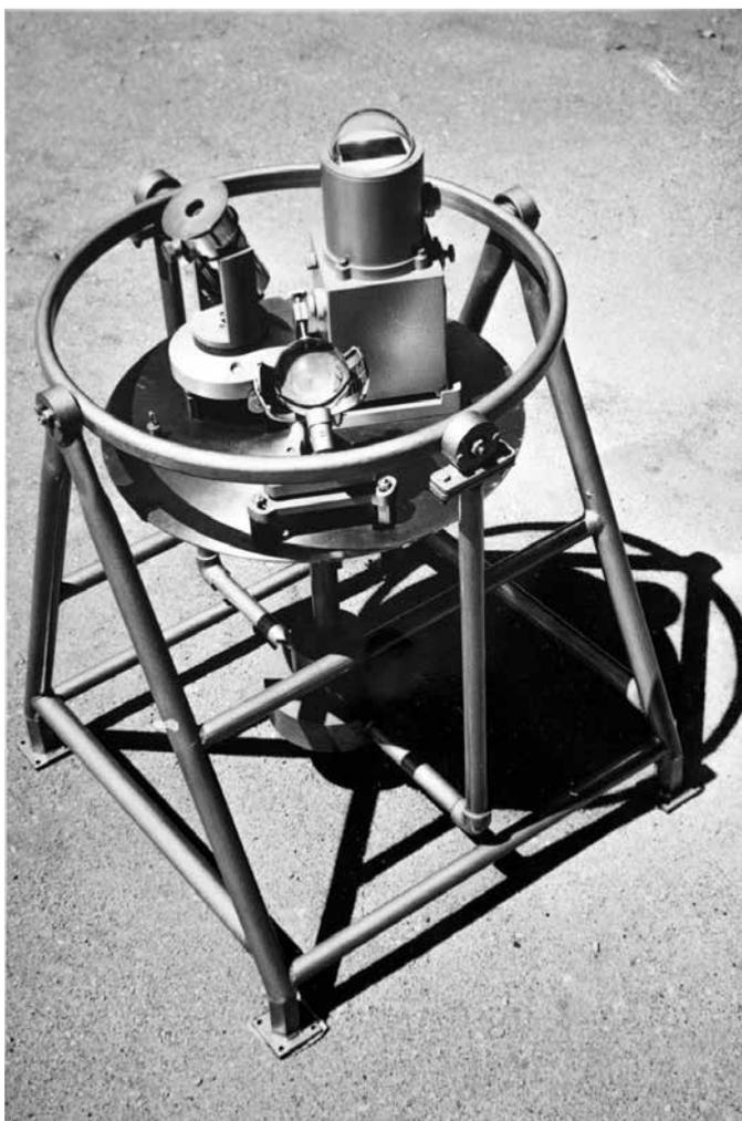
::: Pirheliómetro junto a otros dos instrumentos para medición de radiación solar. Fuente: Laboratorio de Energía Solar UTFSM
