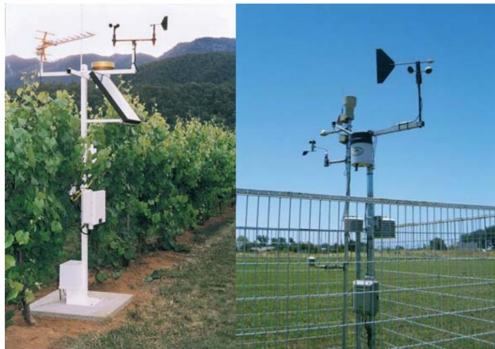
La primera estación está ubicada en condiciones de referencia, sobre una cubierta de pasto de 15 a 20 centímetros y sus datos son extrapolables para otras áreas de microclimas similares. En cambio las estaciones localizadas en los cultivos sirven para esa zona en particular.
