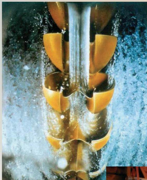
Las turbinas pelton se utilizan cuando se dispone de bastante altura y bajo caudal.
