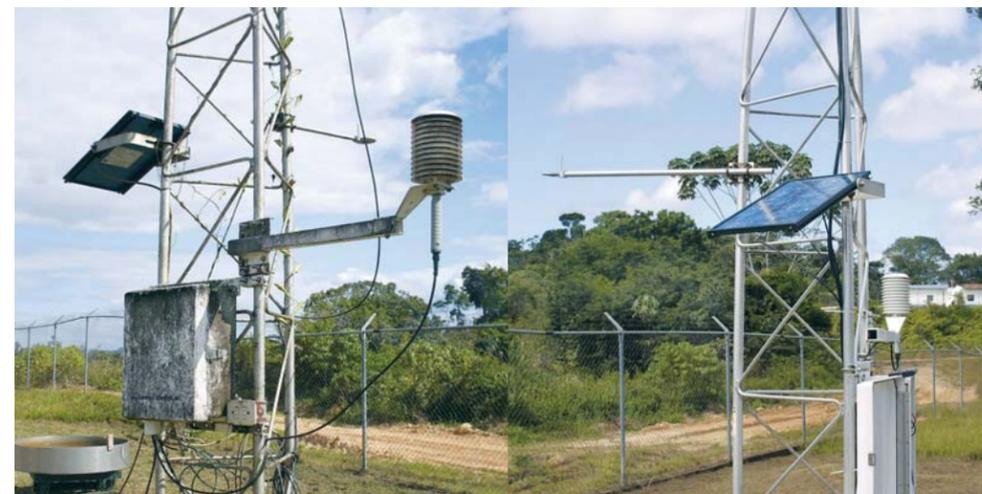
El mantenimiento de las estaciones es clave. A la izquierda una estación sin mantenimiento por dos años en Venezuela, y a la derecha una en óptimas condiciones.
