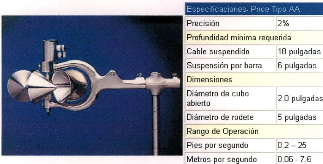
**Figura 48.** Imagen izquierda, Molinete Gurley Price, Modelo 622 DF2N. Imagen derecha, especificaciones técnicas del molinete.
