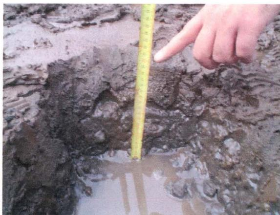
**Figura 49.** Capa de sedimento en el canal.
