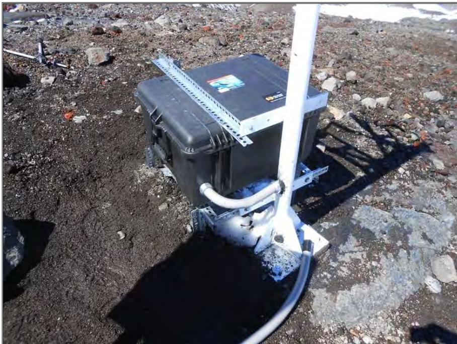
**Fig. 3.2.3-C. Vista de la caja usadas para almacenar baterías, tubería para cables, y perfil para asegurar la tapa.**
