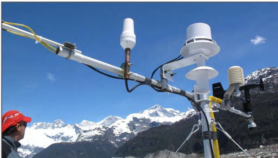
**Fig. 4.2.2.3-A. En el centro de la figura se puede identificar la antena del sistema de transmisión Iridium instalada sobre el brazo de la estación meteorológica GEUS.**
