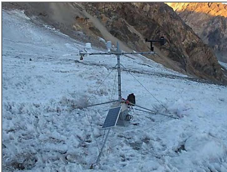
**Fig. 2.2.1.1-A. Estación meteorológica GEUS, con su configuración y emplazamiento definitivo, glaciar Bello.**
