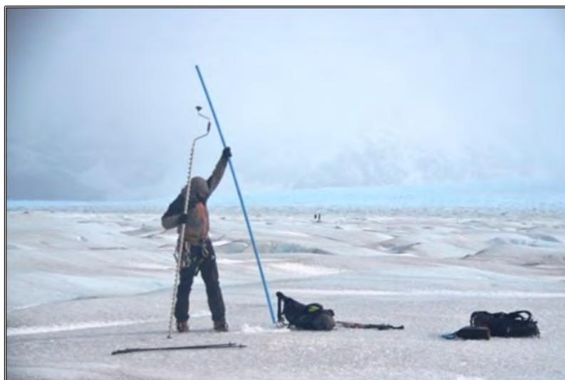
**Fig. 4.3.1.1.1-A. Instalación de balizas en perforaciones en hielo.**
