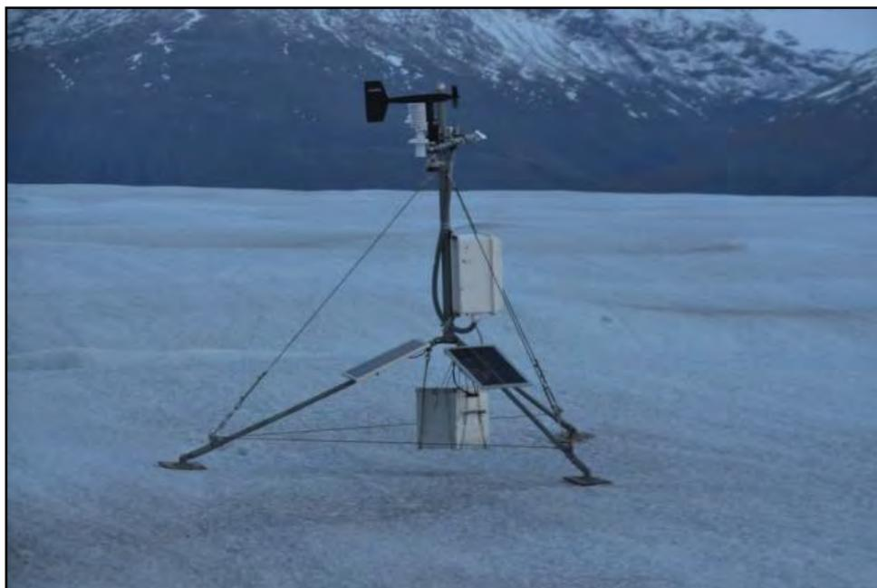
**Fig. 4.3.1.3.1-A. AWS GEUS instalada sobre el glaciar en la transecta Raymond levemente inclinada hacia la izquierda.**
