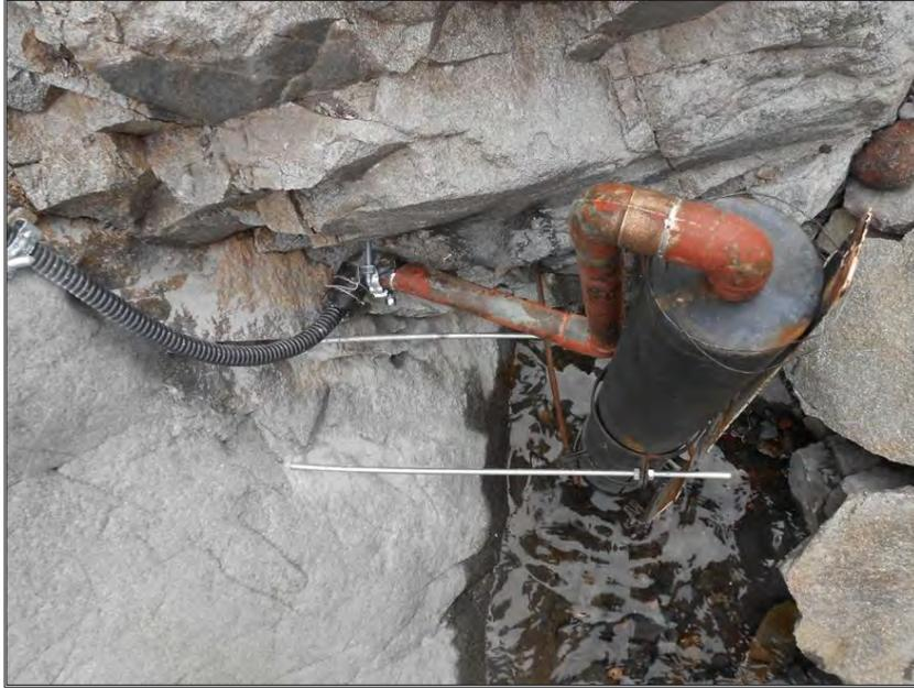
**Fig. 3.2.2.2-D. Modificación a los tubos de protección del sensor.**
