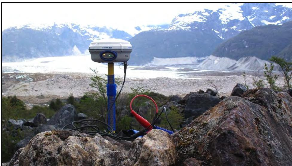
**Fig. 4.2.1.2.1-A. Base GNSS (BEXP) instalada sobre un afloramiento rocoso en el margen frontal del glaciar Exploradores.**
