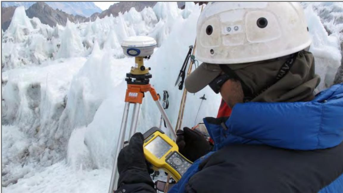
**Fig. 2.2.3.1.2-A. Personal de Geoestudios en el glaciar Bello durante la grabación de datos desde el controlador del receptor GNSS. Se observa el receptor GNSS instalado sobre el trípode y base nivelante.**
