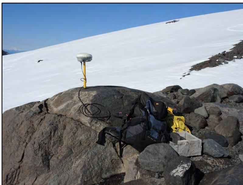
**Fig. 3.2.4.2-A. Estación base GNSS glaciar Mocho (BMCH).**
