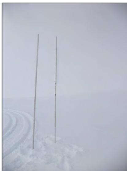
**Fig. 3.2.1.6-A. Baliza de acumulación (aluminio) en B17.**
