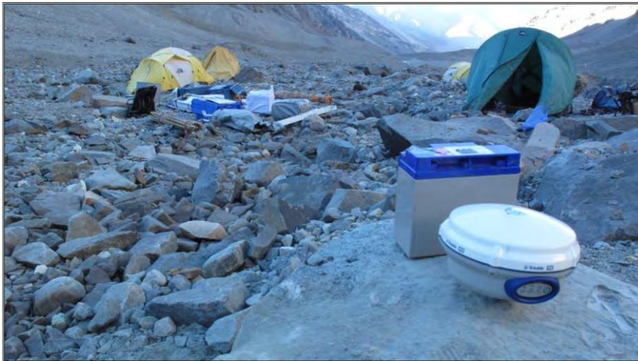
**Fig. 2.2.3.1.1-A. Receptor GNSS Trimble R6 y batería de alimentación instalado sobre roca sólida junto al campamento base.**
