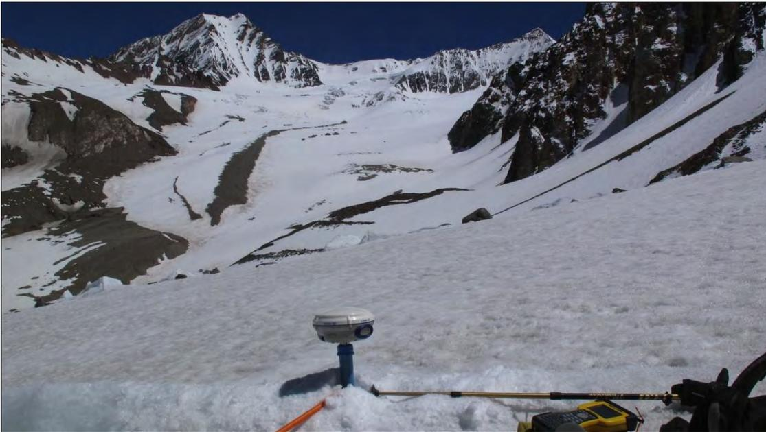
**Fig. 2.2.3.3-A. En la imagen se observa el receptor GPS móvil ubicado en la baliza T7 del glaciar Yeso.**
