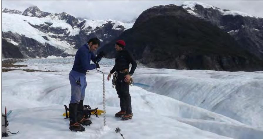
**Fig. 4.2.1.1.1-A. Instalación de balizas en terreno, glaciar Exploradores.**
