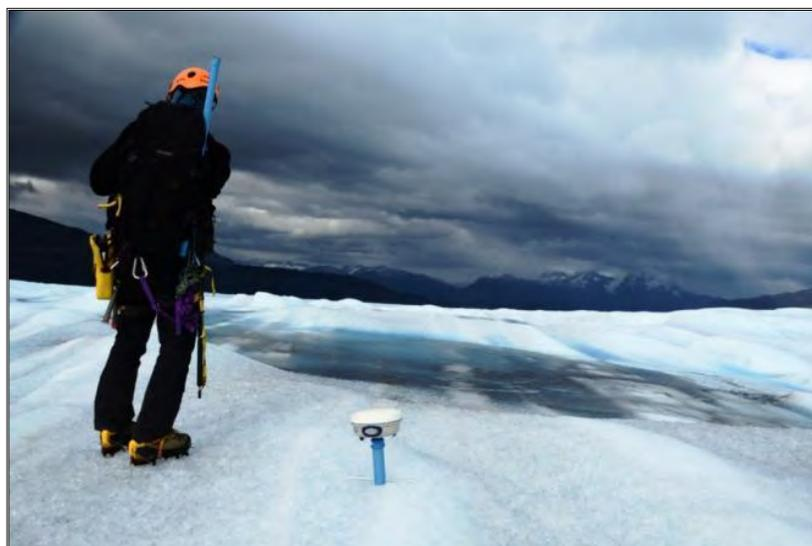
**Fig. 4.3.1.2.1-B. Medición GNSS estática mediante tubo de PVC (ver texto) en puntos de balizas perforados en hielo.**
