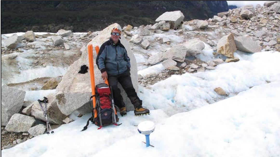
**Fig. 4.2.1.2.3-A. DGPS móvil midiendo en modo estático en la perforación de una de las balizas del glaciar Exploradores.**
