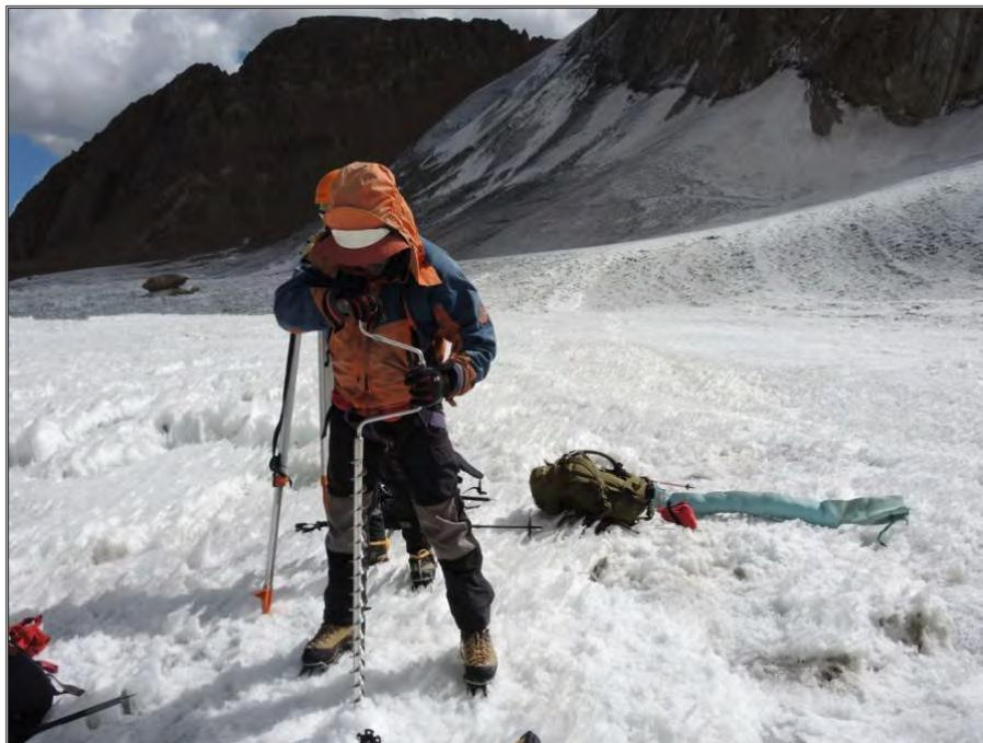
**Fig. 2.2.2.1-A. Perforación manual en el hielo para instalación de baliza en el glaciar Bello con el taladro Ice Auger de Kovacs.**
