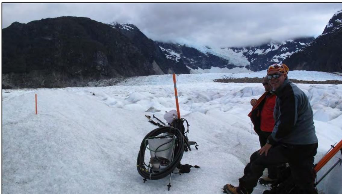
**Fig. 4.2.1.1.3-A. Perforación con taladro a vapor e instalación de balizas de PVC en el glaciar Exploradores.**
