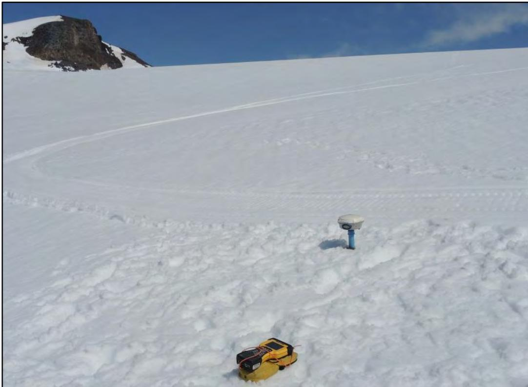
**Fig. 3.2.4.2-B. GNSS móvil montado sobre la baliza de ablación B10.**
