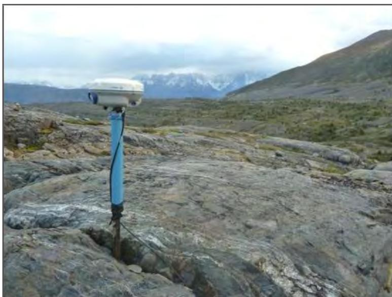
**Fig. 4.3.1.2.1-A. Estación base GNSS (BTDL) instalada en roca firme en las cercanías del campamento base.**
