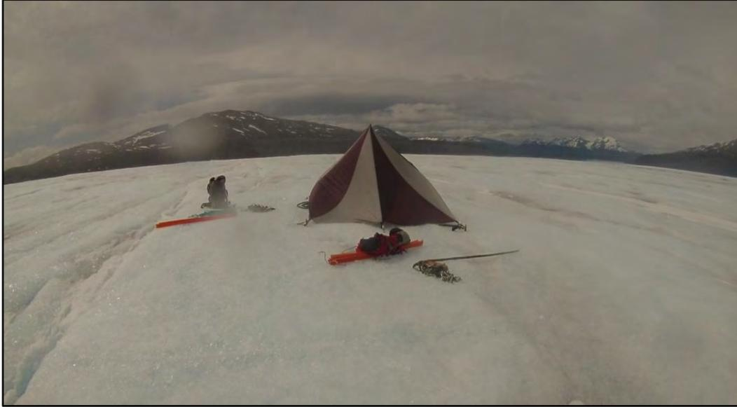
**Fig. 4.3.1.1.3-A. Perforando el hielo con taladro a vapor protegido por una carpa durante la operación con condiciones de viento.**
