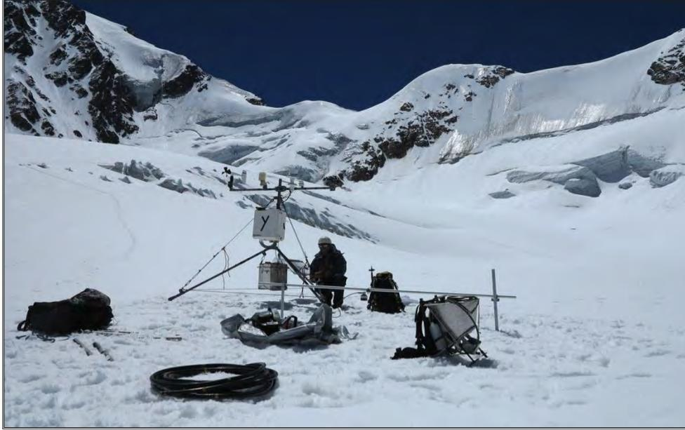
**Fig. 2.2.1.3-B. En la imagen se observa la estación GEUS en el glaciar Yeso con el marco de ablación correspondiente.**
