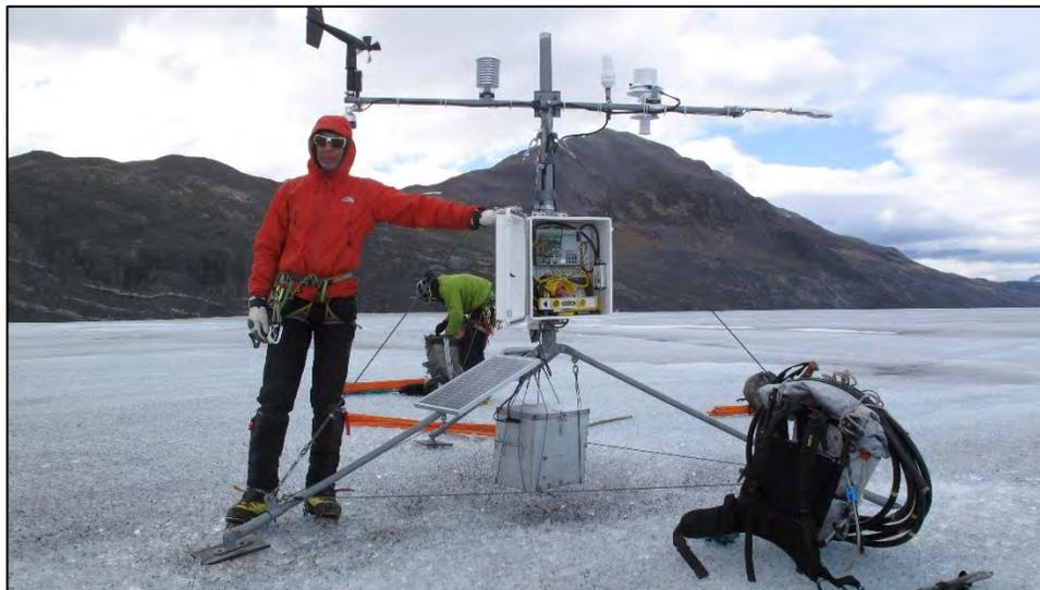
**Fig. 4.3.3-B. Estación meteorológica en el glaciar Tyndall.**
