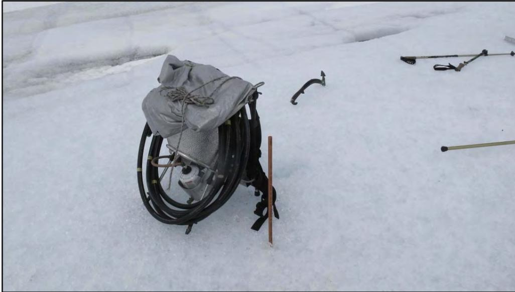
**Fig. 4.3.1.1.3-C. Baliza T8 recién instalada junto al taladro de hielo.**
