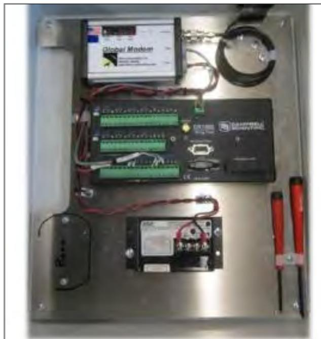
**Fig. 6.1-A. Modem para transmisión de datos satelitales.**
