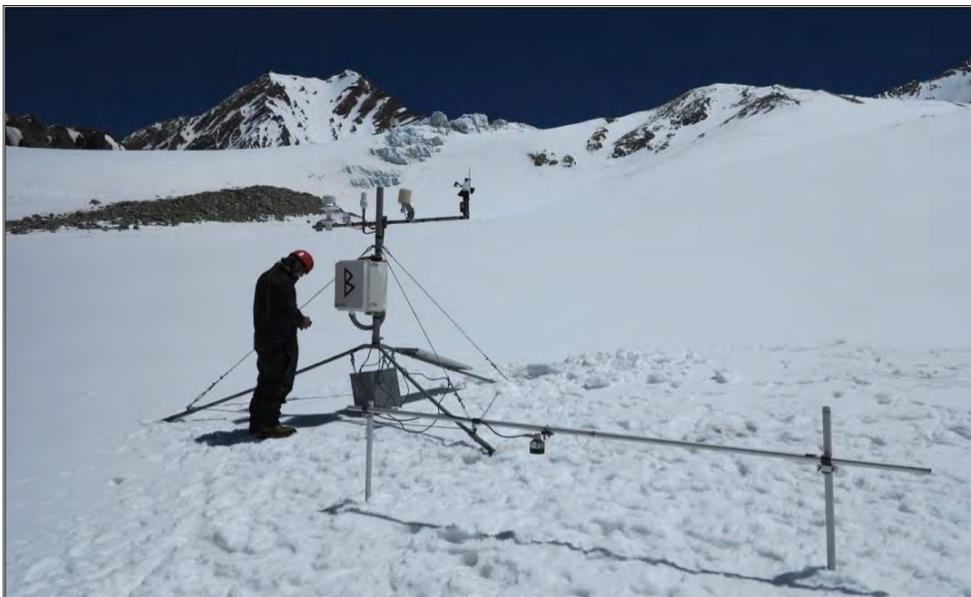
**Fig. 2.2.1.3-A. En la imagen se observa la estación GEUS en el glaciar Bello con el marco de ablación correspondiente.**
