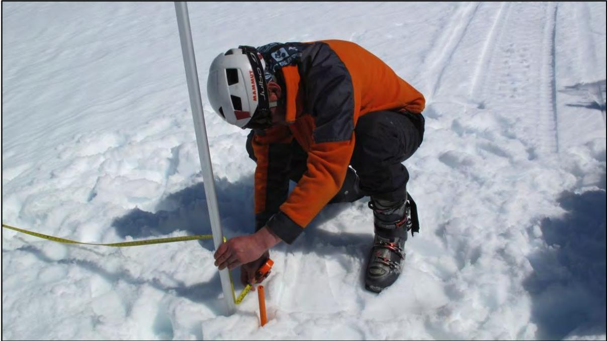
**Fig. 3.2.1.7-B. Control de balizas de acumulación (aluminio) en el volcán Mocho. Inmediatamente a la derecha se observa una baliza de PVC naranja de ablación.**
