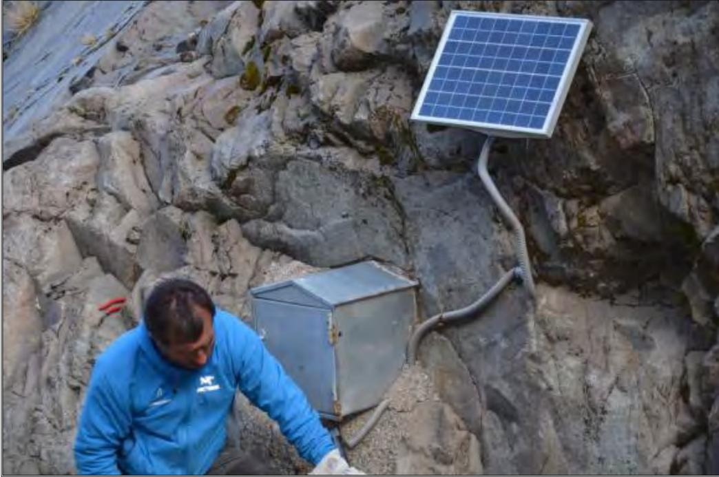
**Fig. 3.2.2.1-C. Panel solar instalado y conectado a la caseta del data logger.**
