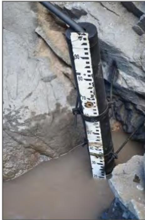
**Fig. 3.2.2.1-E. Tubo porta sensor de presión y limnómetro.**
