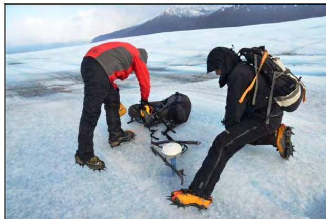
**Fig. 4.3.1.2.2-B. Control de posición de baliza con equipo GNSS en transecta Japonesa.**
