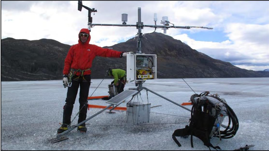
**Fig. 4.3.1.3.3-A. Estacion meteorológica Tyndall correctamente nivelada y con sistema de transmisión de datos funcionando.**
