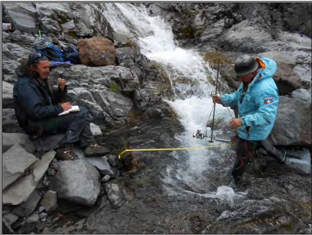
**Fig. 3.2.2.3-A. Sección de aforo donde se realizó la medición de caudal con molinete.**
