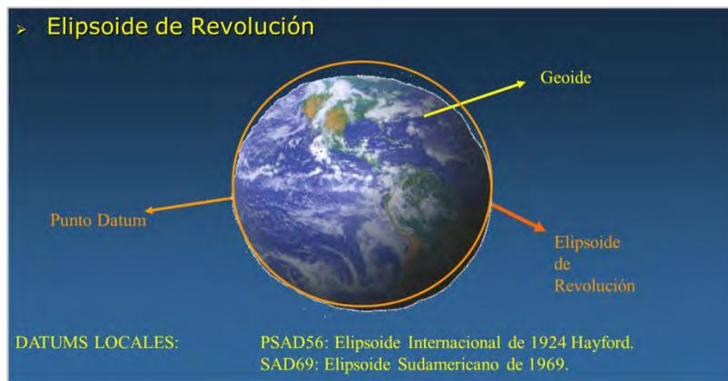
En la practica el concepto de “Elipsoide de referencia” o de “Elipsoide de revolución” no es muy ocupado, ni en GPS, ni en métodos de transformación, pero si puede ser de utilidad para poder identificar cartografías que no indiquen el DATUM y que si indiquen el elipsoide, teniendo este dato se puede deducir el DATUM, en todo caso esta situación es poco común.
