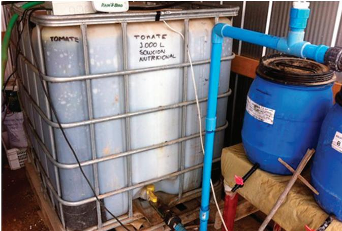
**Figura 10.** Sistema de fertirriego consistente en dos estanques de 1.000 litros para preparar la solución nutritiva, un programador, bomba impulsora y válvulas eléctricas.
