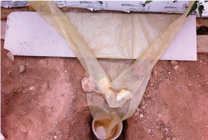
**Figura 12.** Detalle de la lámina para recibir y conducir el agua de drenaje y el recipiente de acumulación.
