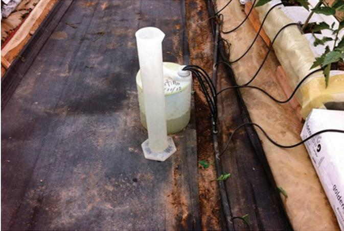
**Figura 13.** Unidad para recibir y medir el agua aplicada. Consta de 4 emisores idénticos a los que aplican el riego a las tablas con sustrato y un recipiente de boca estrecha (bidón).
