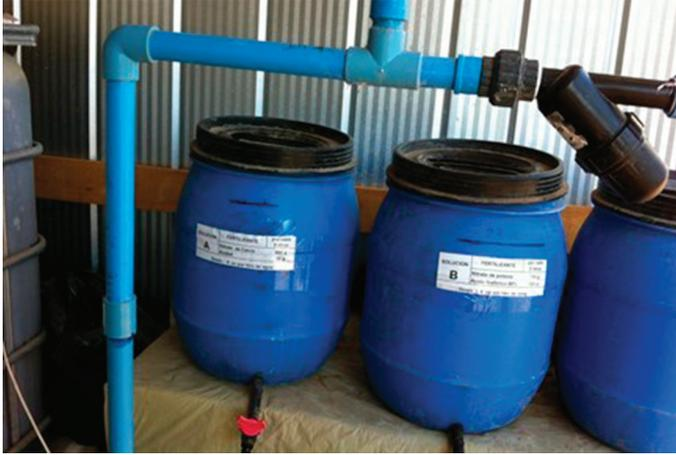
**Figura 3.** Contenedores de 25 litros para soluciones concentradas A y B
