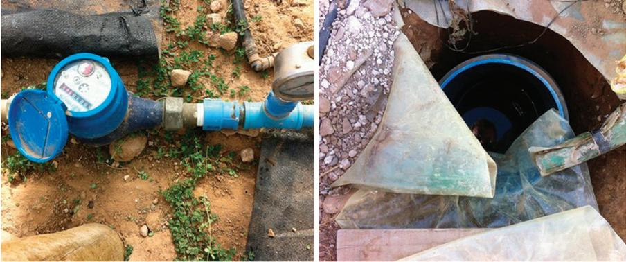
**Figura 20.** Caudalímetro para medir agua aplicada y tambor bajo nivel del suelo para recibir el agua de drenaje de las tablas de fibra de coco
