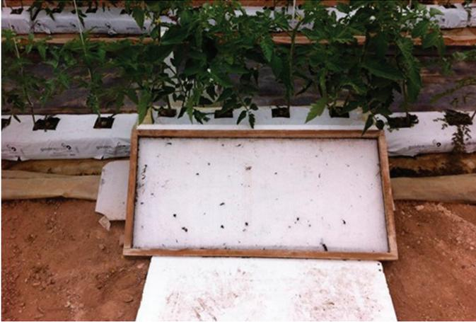
**Figura 11.** Sistema para recibir y medir el agua drenada por una unidad de sustrato (tabla de fibra de coco), cubierta para protegerla de la radiación solar e impedir la proliferación de algas.
