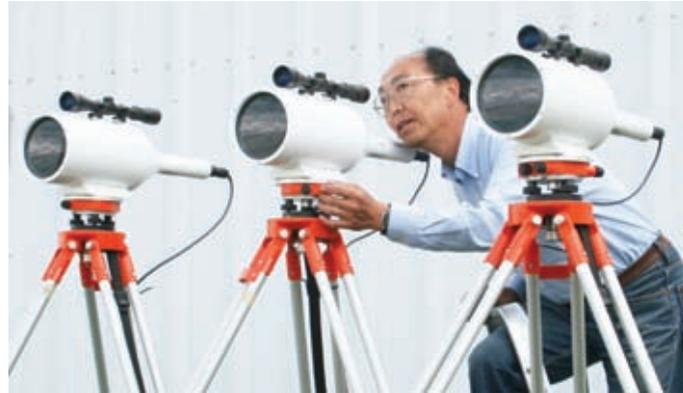
Los cintilómetros (scintillometers) proporcionan mediciones del índice de refracción, el cual es usado para obtener el parámetro de estructura de la temperatura y el flujo de calor sensible. Las estadísticas de turbulencia utiliza la desviación estándar de la temperatura del aire para calcular el flujo de calor sensible.
