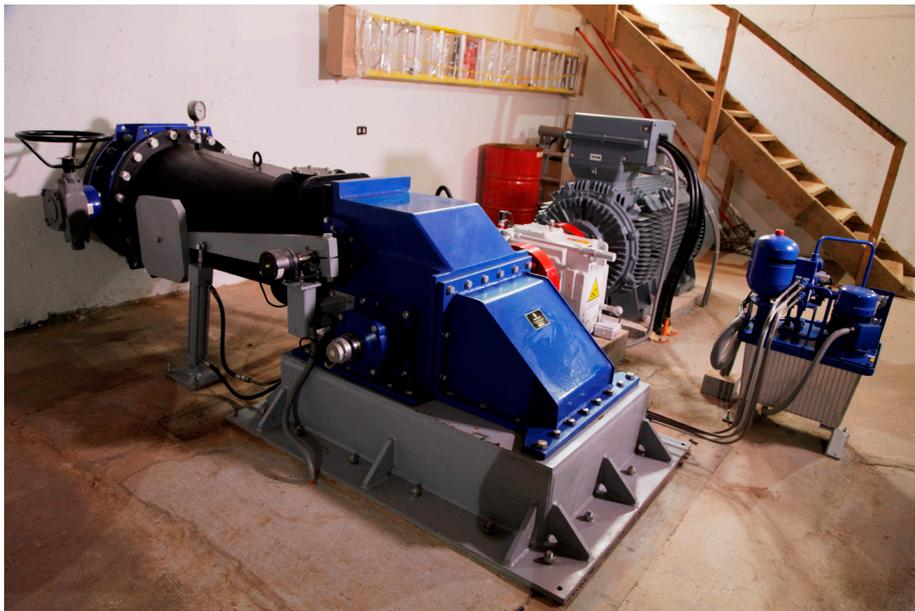
**Fig. 5.2 - Turbina Flujo Cruzado instalada en Faja Maisan - Chile.**
