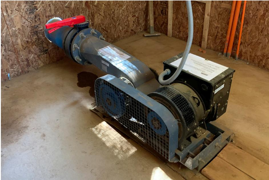
**Figura 7.49 - Turbina hidráulica con adecuadas rejillas de protección en partes móviles.**
