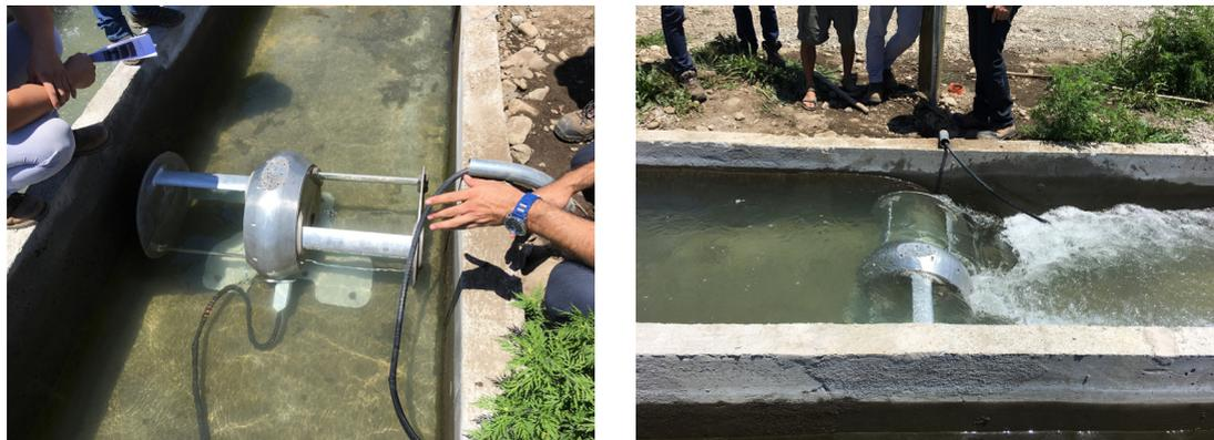
**Fig. 4.20 - Turbina hidrocinética de 0,5kW instalada en Linares - Chile.**
