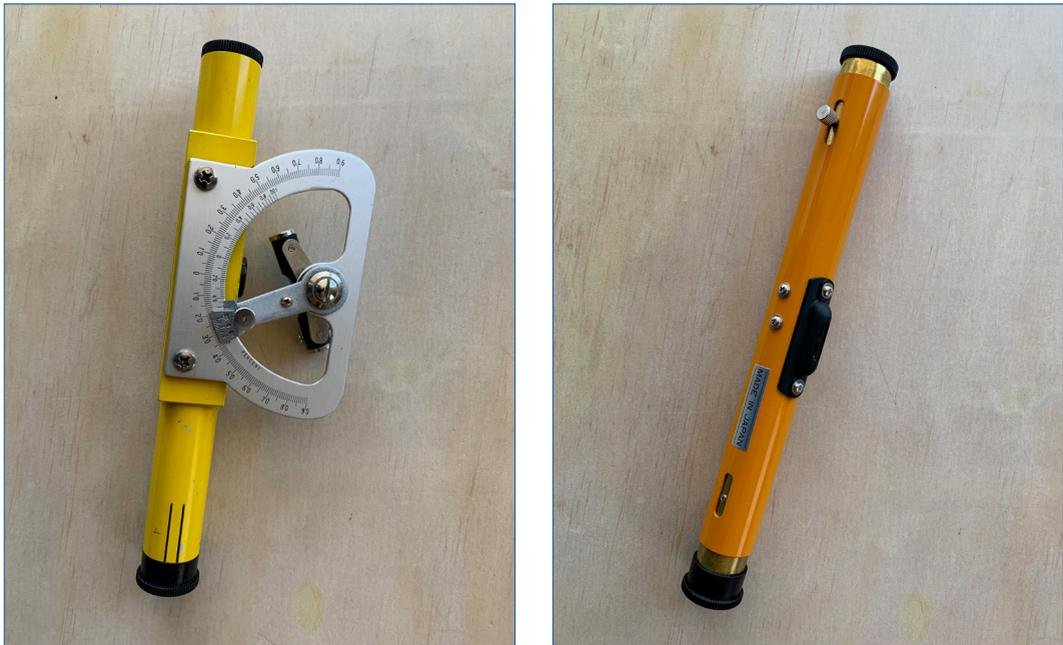
**Fig. 6.14 - Nivel Abney (Eclímetro) con goniómetro.**
