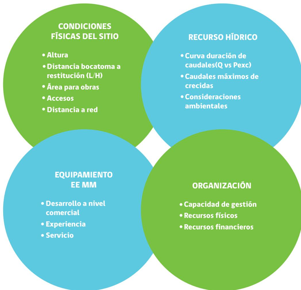
Fig. 3.1 – Elementos básicos para el desarrollo de un aprovechamiento hidroeléctrico.
