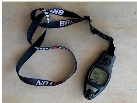
**Fig. 6.13 - Uso del altímetro para medir la altura.**
