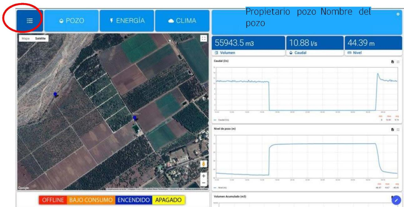
Los otros dos botones de energía y Clima son para otras funcionalidades no incorporadas en la solución DGA. Energía sirve para monitorear consumos de energía y eficiencia energética en los pozos. Clima es usado cuando además se instala una estación meteorológica para conocer variables climáticas. El botón "lista" (rojo) sirve para alternar entre vista mapa y lista.
