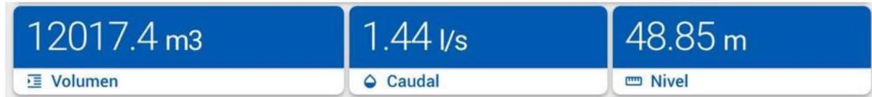
Con estos tres widgets se presenta información en tiempo real del pozo. El volumen extraído hasta el momento, caudal actual de extracción y nivel de agua en el pozo. Este nivel se mide desde la superficie de terreno en el pozo.
