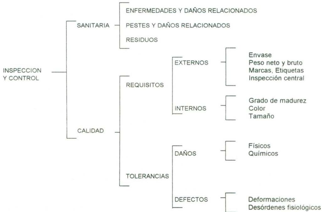
Figura 1. Esquema general para la inspección de frutas para la exportación.
