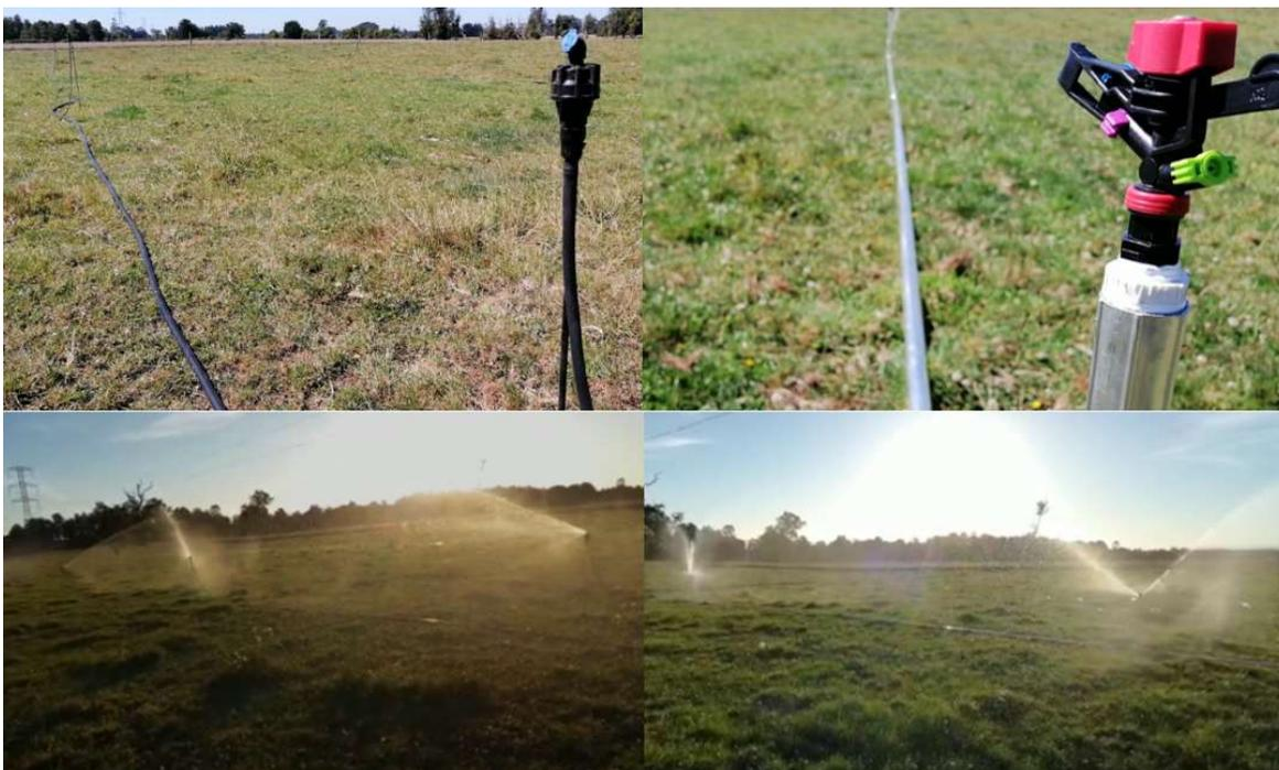
Fotografía 23. Sistema de riego por aspersión con conducción en HDPE (izquierda) y en aluminio (derecha).
