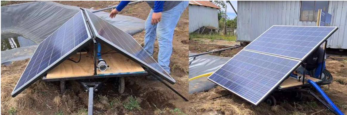
Fotografía 25. Sistema móvil fotovoltaico con electrobomba solar.
