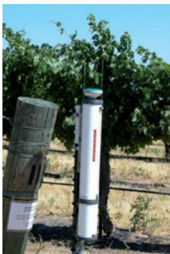
Los atmómetros cilíndricos miden la pérdida de agua de una superficie porosa mojada.
