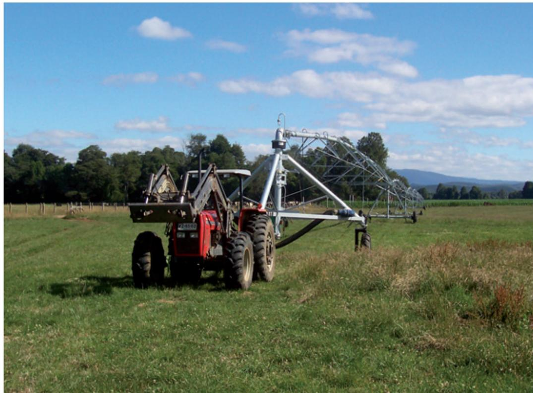
*Existen sistemas móviles (transportables), ej. pivotes, por lo que los efluentes pueden ser aplicados sobre diferentes campos, reduciendo la potencial excesiva acumulación de nutrientes y la degradación medioambiental.*
