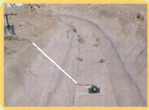
Sonda para medición de caudal ubicada en el fondo del canal
