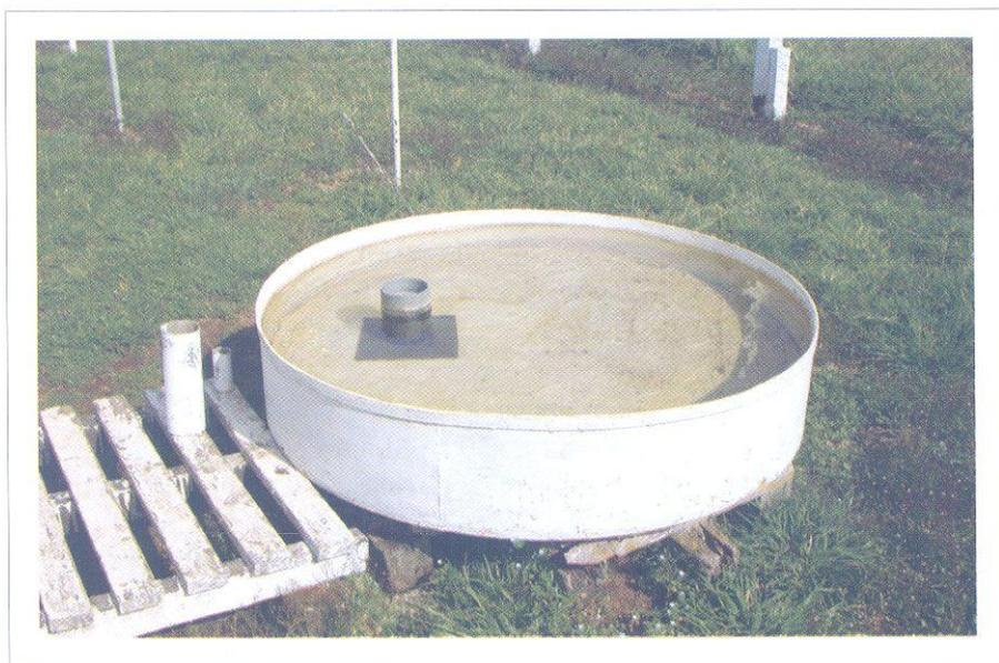
**Figura 9.6** Vista de un evaporímetro de bandeja Clase A usado para estimar  $ET_c$ .
