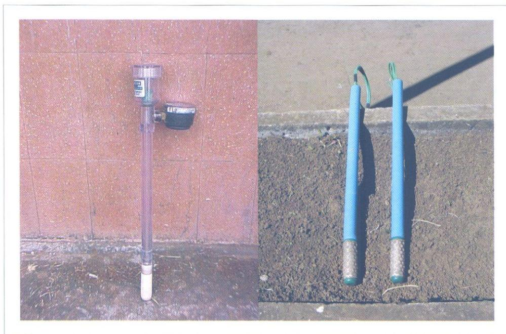
**Figura 9.8** Tensiómetro y Watermarks®, equipos que permiten medir la tensión del agua en el suelo.
