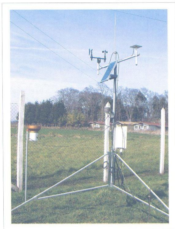
**Figura 9.7** Estación agrometeorológica automática, la que apropiadamente usada, puede estimar evapotranspiración de cultivos.
