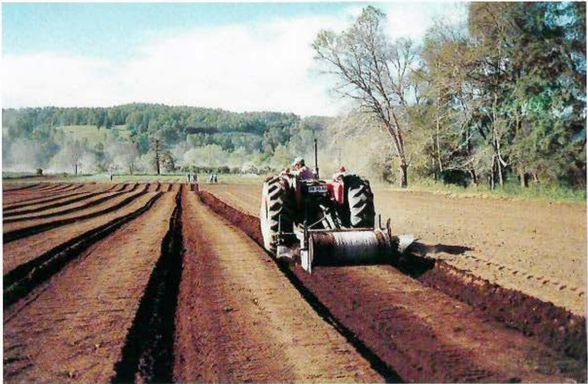
Máquina platabandera de la empresa EMASIL, Valdivia, adaptada por el Ing. Forestal Edmundo Cornuy. La máquina construye platabandas de aprox. 1,10 m. de ancho y 10 cm. de altura sobre nivel. El rendimiento es aprox. de 7000 - 8000 metros lineales de platabanda por jornada. (En la foto la máquina está trabajando en el vivero Pullingue).
