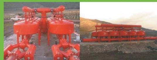
Batería de Filtrado con Filtro Malla Modular
