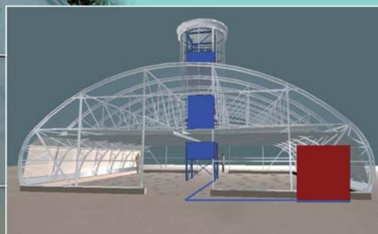
**Flujo de calor:** El intercambiador de calor extrae el calor del interior del invernadero. Durante el día, el calor recogido se acumula en un depósito de agua externo. Durante la noche, el calor recogido se puede devolver al invernadero para calentarlo. De este modo, se enfría el agua del acumulador de calor y se puede usar para la refrigeración del día siguiente.
