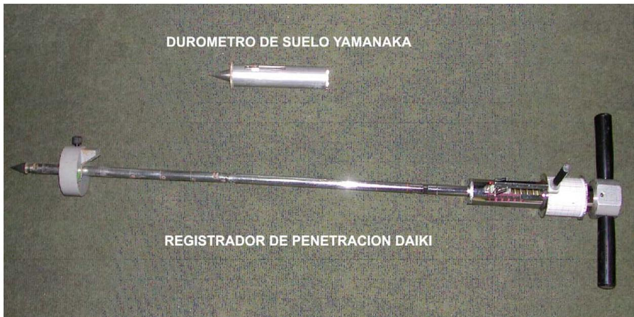
**Foto 4.1. Penetrómetros. Arriba: durómetro de suelo YAMANAKA. Abajo: Registrador de penetración DAIKI.**
