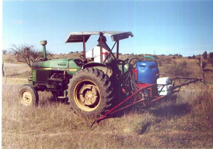
**Figura 6.3. Efecto de la pendiente en la barra de pulverización.**
