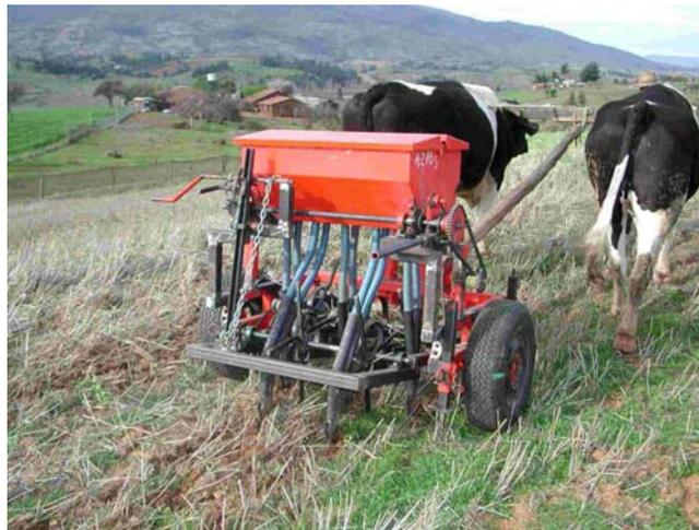
**Figura 6.13. Sembradora de cero labranza de tracción animal de cinco hileras marca INDEMAF**
