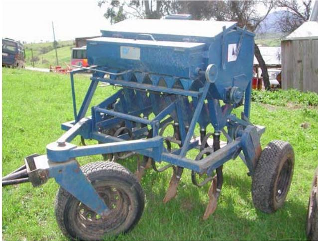
**Figura 6.12. Sembradora cero labranza de tiro animal marca LV.**
