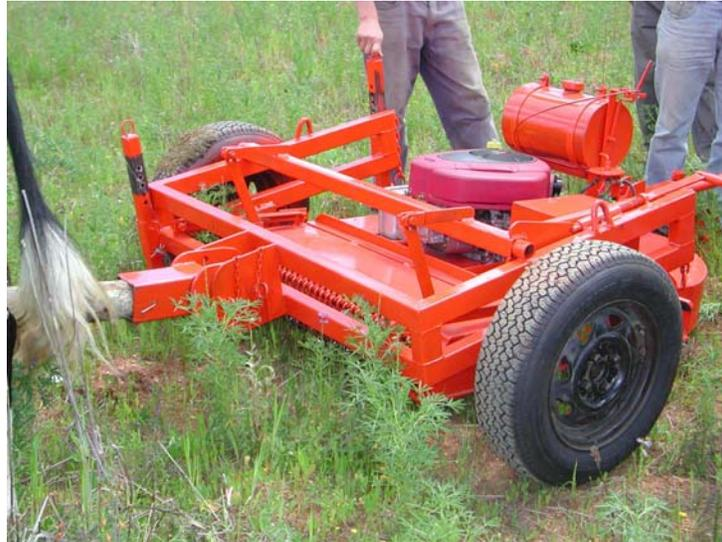
**Figura 6.9. Desbrozadora rotativa con motor y traccionada por bueyes.**
