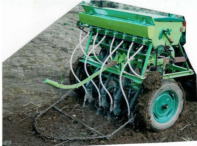
**Figura 6.11. Sembradora de cero labranza de tracción animal con abresurco cincel.**
