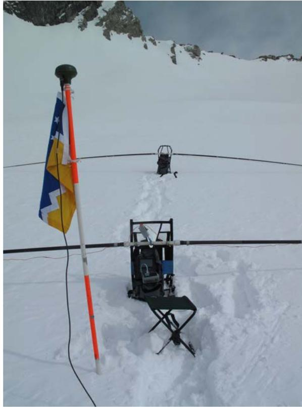
Figura 4.9: Disposición del equipo de radio eco sondaje sobre la superficie del glaciar Echaurren Norte junto a la antena móvil del GPS, para comenzar a realizar las mediciones
