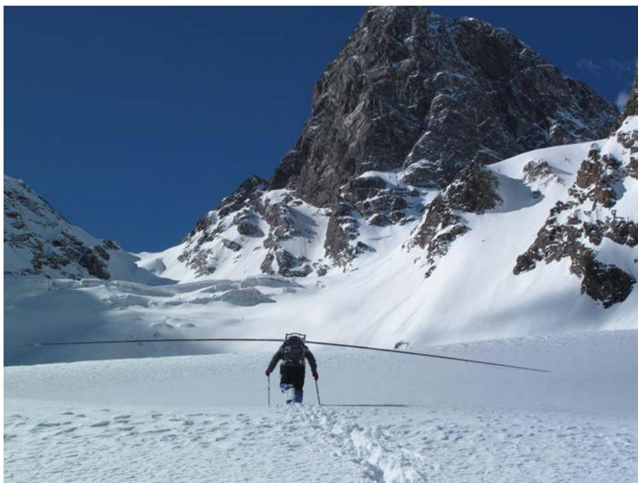
Figura 4.6: Desplazamiento del sistema de radar sobre el glaciar San Francisco (Etapa transmisora)
