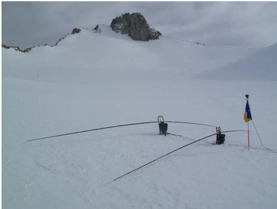
Figura 4.3: Sistema de radar, transmisor, receptor y sus antenas instaladas sobre crochet para ser transportado a pie sobre la superficie del glaciar junto a la antena móvil de uno de los GPS's
