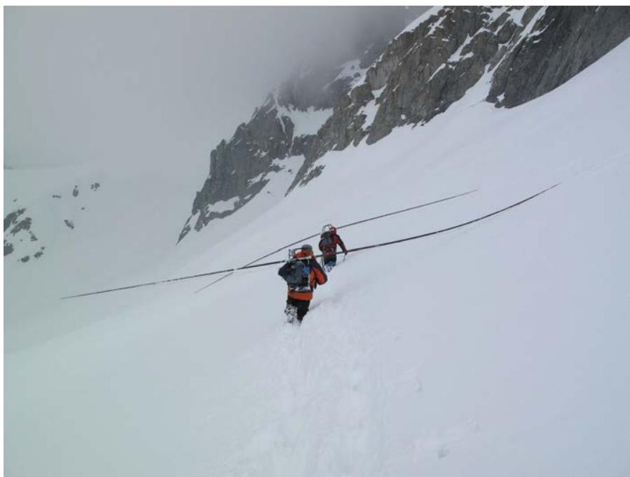
Figura 4.4: Personal de la Universidad de Magallanes sobre el glaciar Echaurren Norte, realizando mediciones de espesor utilizando el sistema de Radio Eco-sondaje
