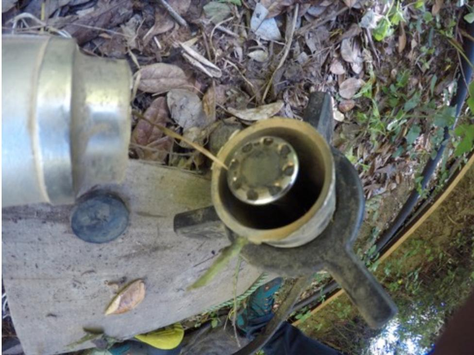
Fotografía 8. Bomba sumergible dañada.
