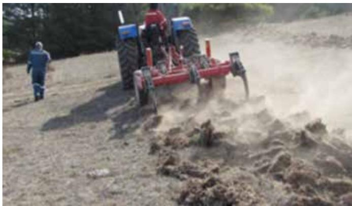
**Foto 1.** Labor de subsolado o “escarificado” en fajas, con cinco puntas, para romper capa compactada de suelos y facilitar la infiltración de aguas lluvias al suelo. Litueche, Región de O'Higgins.
