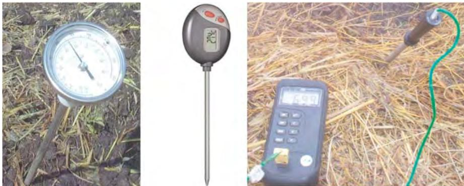
**FOTOGRAFIA 65: TERMÓMETROS UTILIZADOS PARA CONTROLAR LA TEMPERATURA DE LAS PILAS DE COMPOST**
