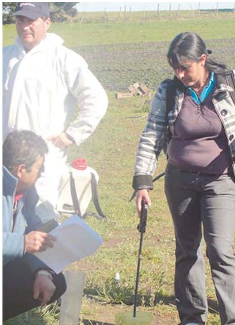
FOTOGRAFIA 70: MEDICIÓN DEL CAUDAL DE LA BOQUILLA.
