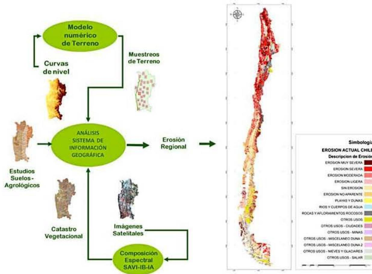
Figura 4. Diagrama metodológico del modelo de erosión actual.
