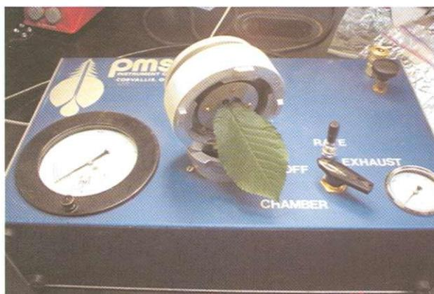
**Foto 8.** Cámara de Scholander para la medición del potencial hídrico de árboles de cerezo, como apoyo a la programación del riego en el huerto frutal.
