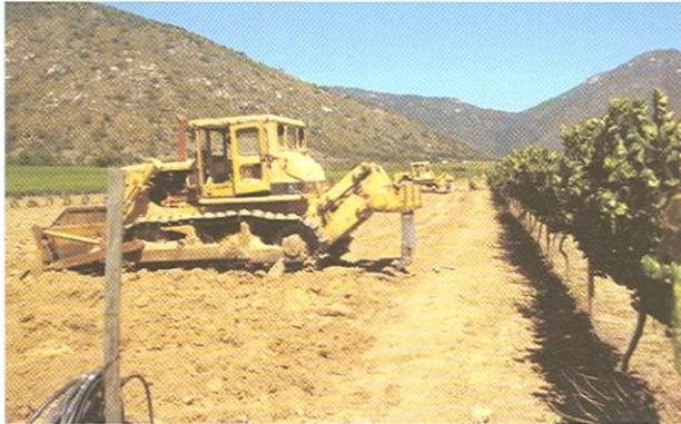
**Foto 5.** Tractor sobre orugas o “Bulldozer” con subsolador, apropiado para labores profundas en suelos secos o con bajo contenido de humedad.
