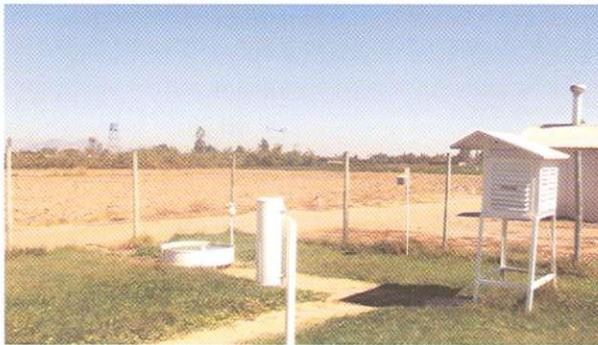
**Foto 2.** Estación meteorológica y bandeja de evaporación Clase A, de apoyo a la programación del riego.
