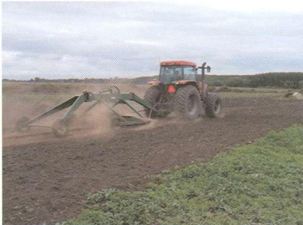
**Foto 13.** Movimiento superficial de suelo con una microniveladora, emparejándolo para el riego.
