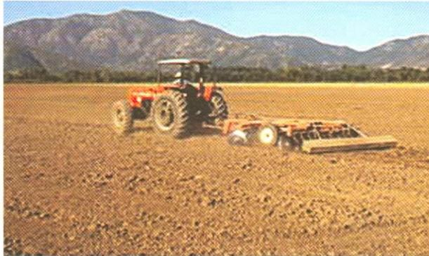
**Foto 14.** Labor de rastraje con Rastra “off-set” y tablón de madera, para favorecer la micronivelación del terreno y proteger la humedad del suelo.
