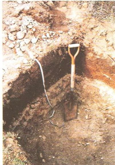
**Foto 1.** La observación del perfil de suelo en una calicata, permite establecer la presencia de algún impedimento físico y definir el tipo de labores de suelo.
