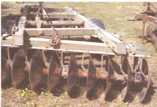
**Foto 11.** Rastra de discos de tipo “off-set”, apropiada para labores de tipo secundarias, de afinado de la cama de siembra.
