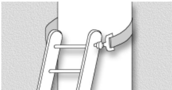
Fig. 41 Medida de seguridad cuando la inclinación es mayor a 75°.
