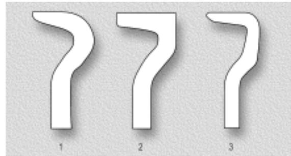
Fig. 71 Clasificación según la forma del diente.
