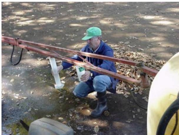
Foto 1. Medición del caudal de la boquilla en una barra pulverizadora.
