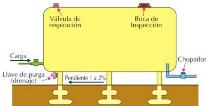
**Figura 2.** Modelo de estanque y recomendaciones, para la carga y almacenaje de combustible.
