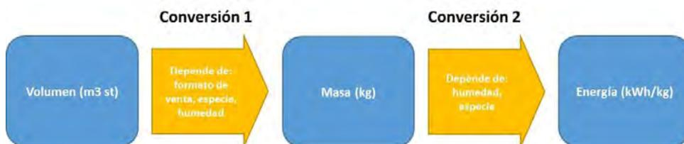
**Ilustración 5:** Conversiones necesarias para llegar a unidades de energía
