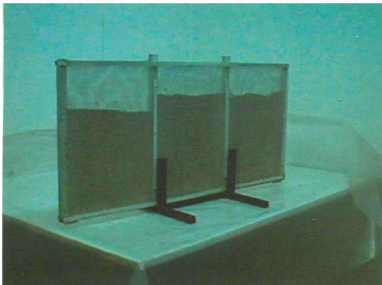
**Foto 3.** Bandejas cribadas sujetas en soportes de carga.
