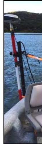
Fotografía N°3. Jalón con sistema RTK móvil (Fuente: DesHielos, nov.2014).
