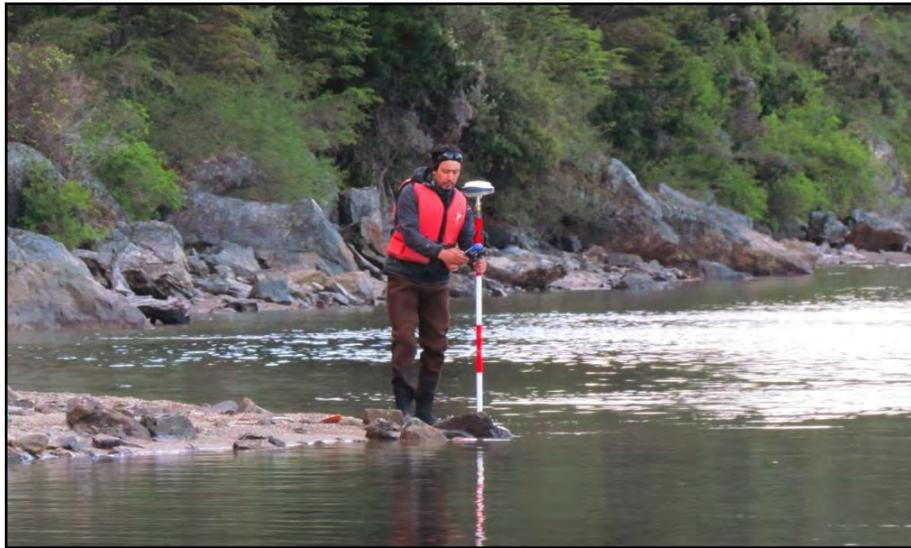
**Fotografía N°18. Medición de puntos de ribera con GPS + RT (Fuente: DesHielos, nov.2014).**
