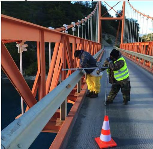
**Fotografía N°51. Sistema de apoyo en aforo de puente desagüe lago G.C (Fuente: DesHielos, dic.2014).**
