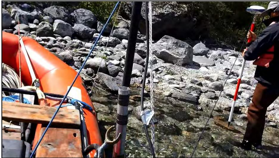
**Fotografía N°16. Medición de puntos de inicio y término en la ribera con GPS + RTK (Fuente: DesHielos, nov.2014).**
