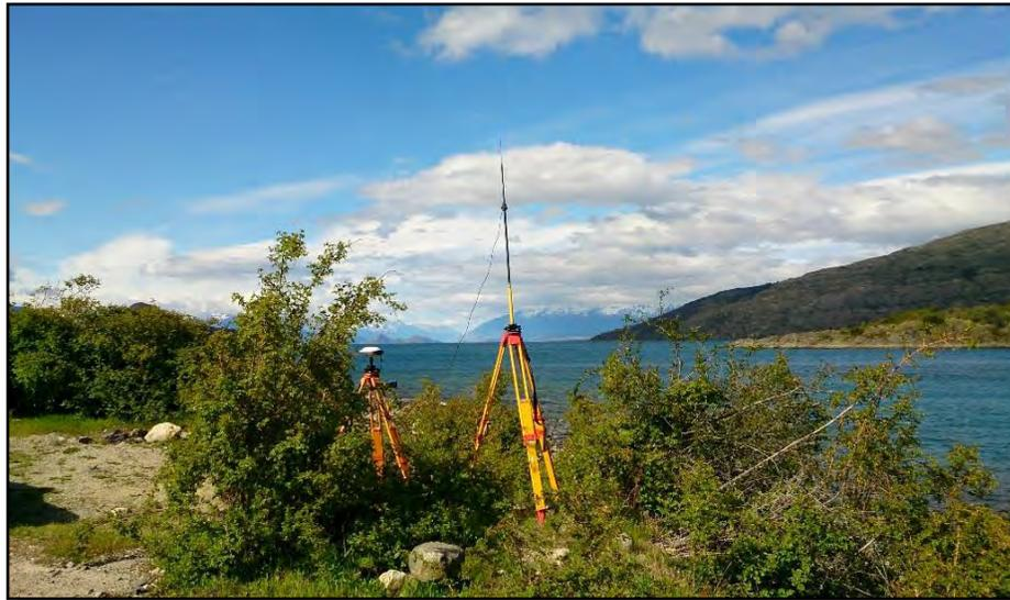
**Fotografía N°14. Antena base GPS en el PR DESA (Fuente: DesHielos, nov.2014).**
