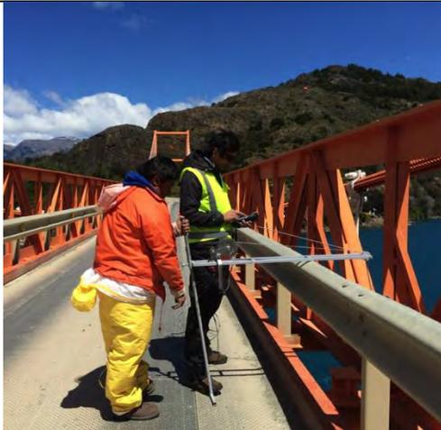
**Fotografía N°49. Aforo desde puente desagüe lago G.C. (Fuente: DesHielos, dic.2014).**
