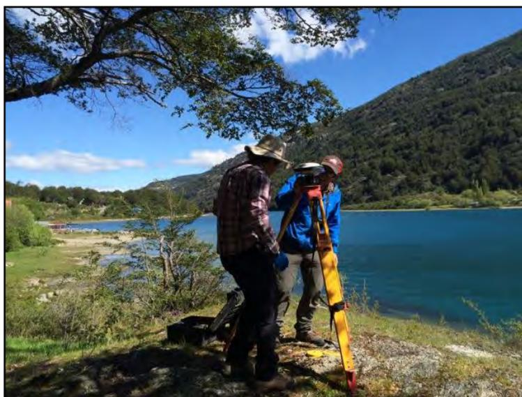
**Fotografía N°11. Antena Móvil sobre monolito en BERT (Fuente: DesHielos, nov.2014).**
