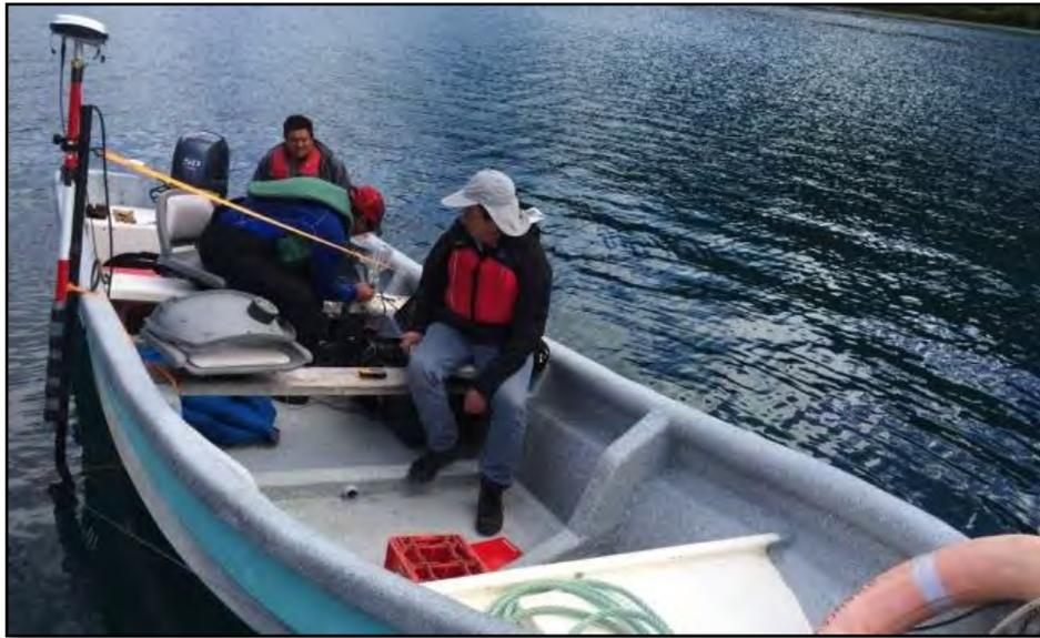
**Fotografía N°17. Montaje de equipo transductor y antena móvil en embarcación (Fuente: DesHielos, nov.2014).**
