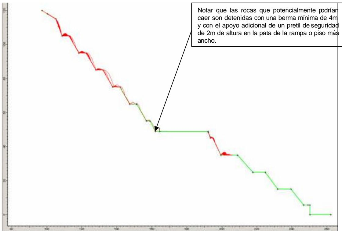
**Figura 2.2.1** Resultados con simulación de caída de materiales desde bancos superiores en SG-01 de Figura 16.
