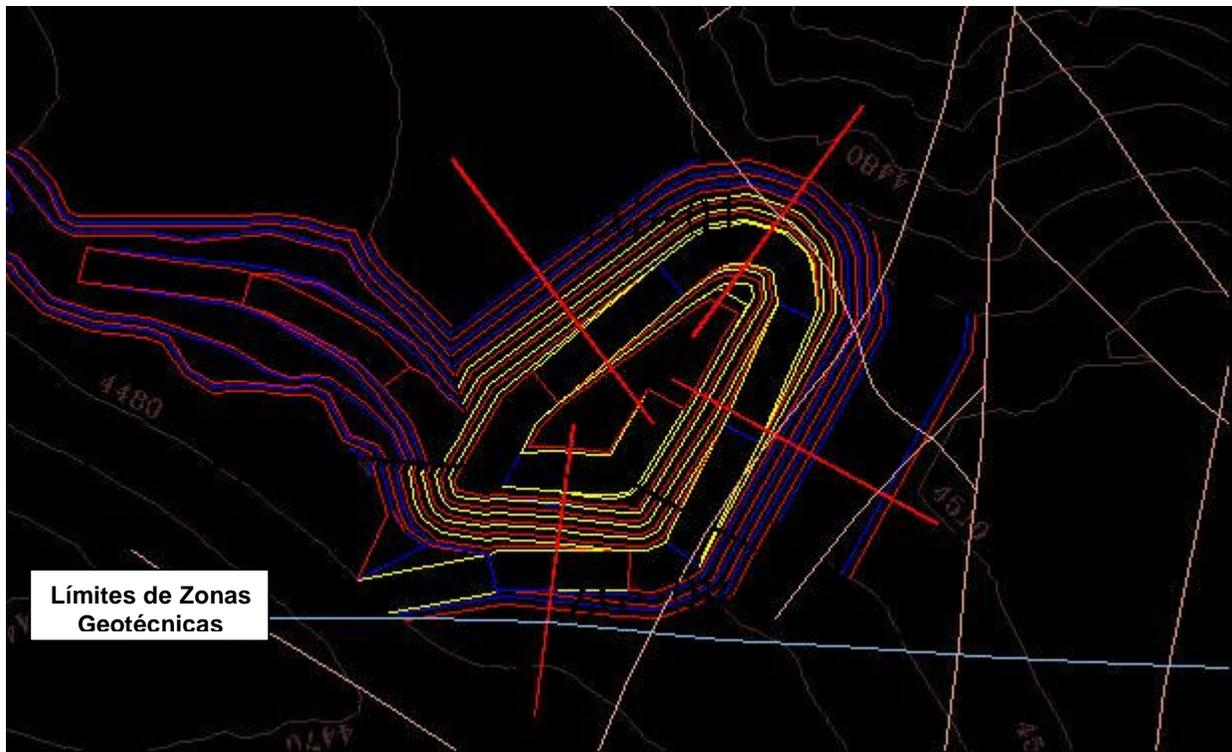
**Figura 9.** Vista de proyecto de rajo Huinquintipa Este Fase V con Zonas Geotécnicas [ZG-01 y ZG-02] y respectivo límite geotécnico definido a través de estructura distrital que espacialmente ocasiona un cambio en los patrones de fracturamiento
