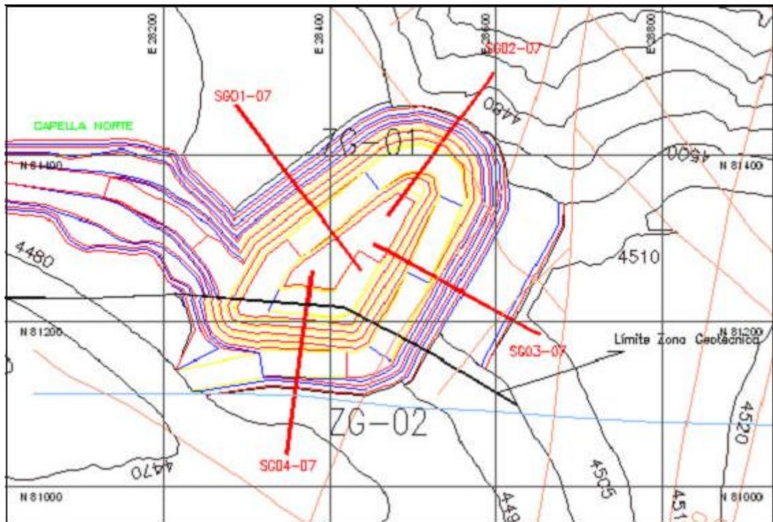
**Figura 14a** Disposición de secciones geotécnicas para análisis banco berma para año 2008 (SG01, SG02, SG03 y SG04)
