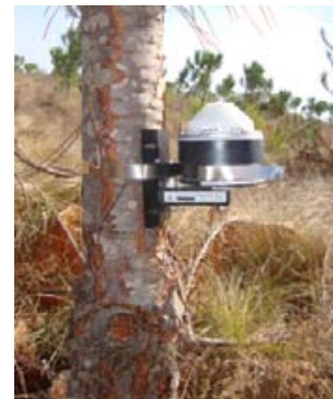
Figura 105. Dendrómetro digital instalado en Región de O'Higgins, Chile
