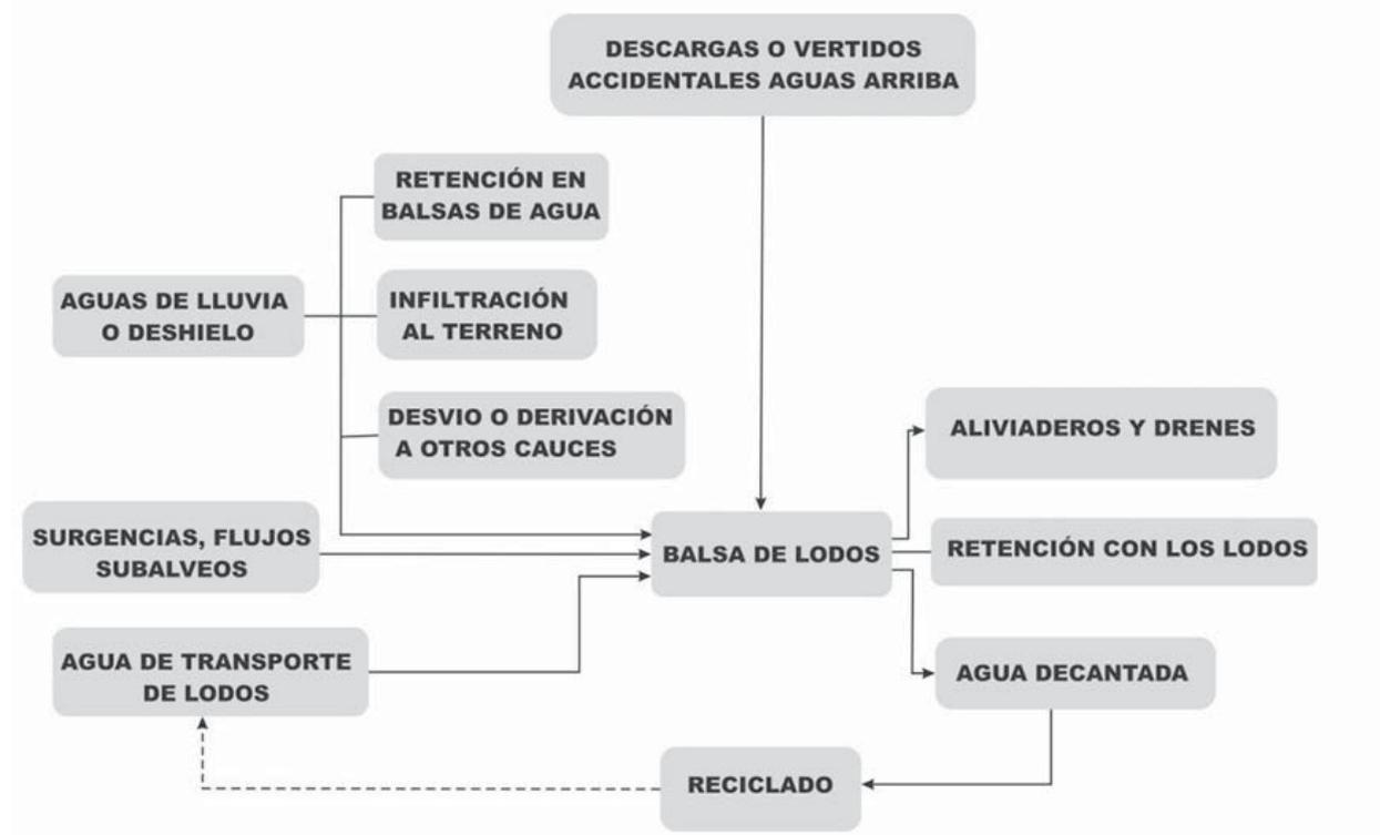
Figura 3.29 Procedencia y Flujo del Agua en las Balsas de Lodos
