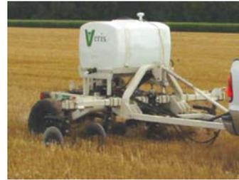
**Figura 6.14:** Barra porta sensores móviles Veris con pH Manager
