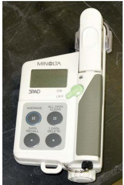
Figura 2.16: Monitor de Clorofila.
