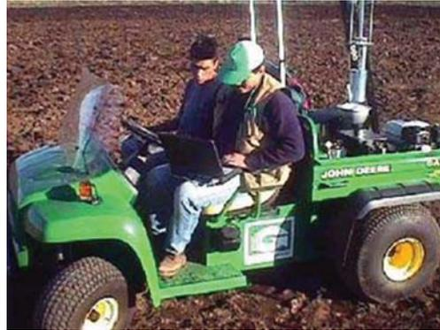
Figura 2.12: Toma de muestras de suelo, georeferenciadas con GPS Diferencial.
