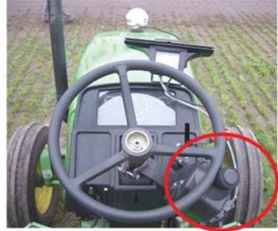
Figura 2.23: Piloto automático montado sobre un tractor.
