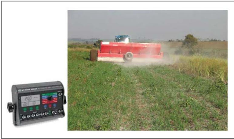
Figura 10.12: Aplicación de dosis variable de calcáreo dolomítico
