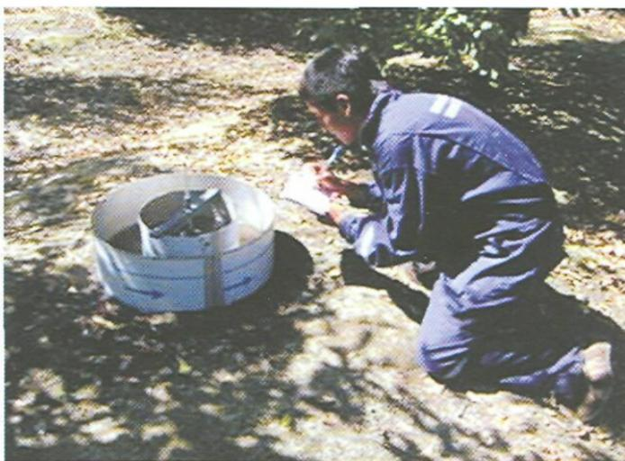
**Foto 10.** Medición de velocidad de infiltración por el método del cilindro doble. Sector El Molino-La Compañía, Comuna de Graneros. Año 2011.
