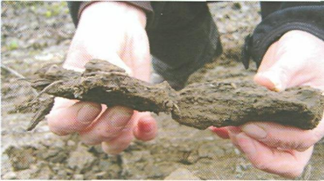
**Foto 4.** Forma característica de un terrón muestreado en un horizonte compactado. Obsérvese la amplitud del eje horizontal, con relación al eje vertical.
