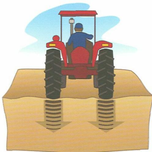
**Figura 1.** Compactación de suelo por acción de las ruedas del tractor.
