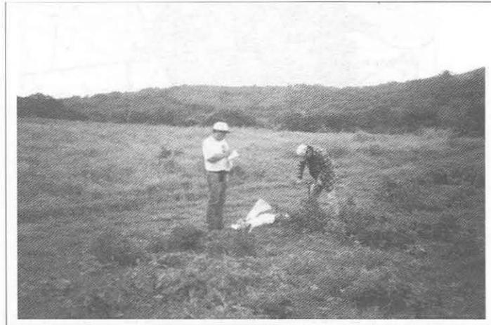
Técnica de toma de muestras de suelos dos profundidades utilizando una barrena edafológica y georeferenciación con GPS de los sitios de muestreo.
