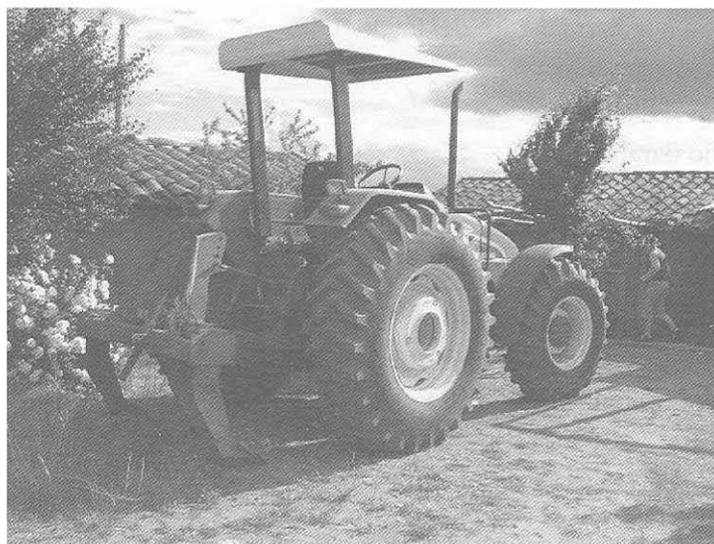
Figura 1. Tractor tracción asistida del Proyecto CADEPA.
