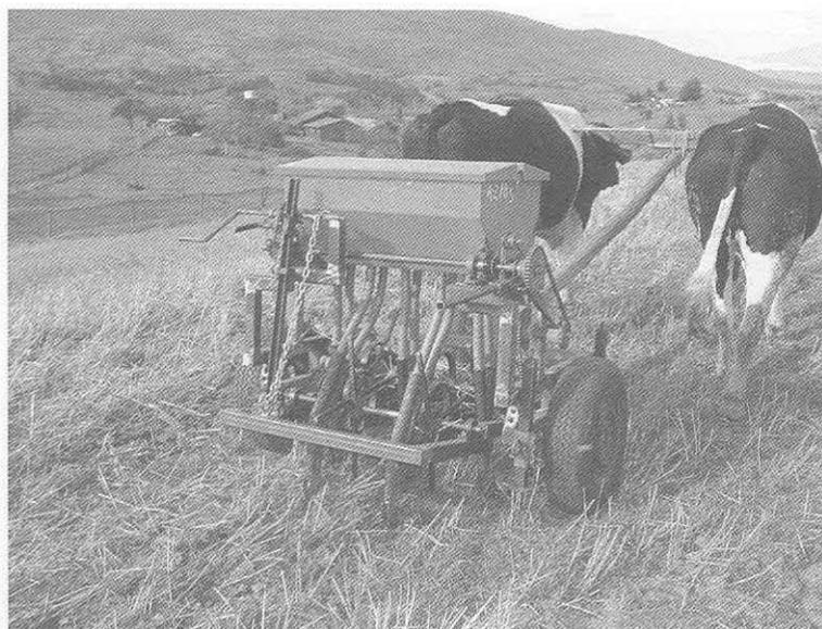
Figura 13. Sembradora de cero labranza de tracción animal de cinco hileras marca INDEMAF.
