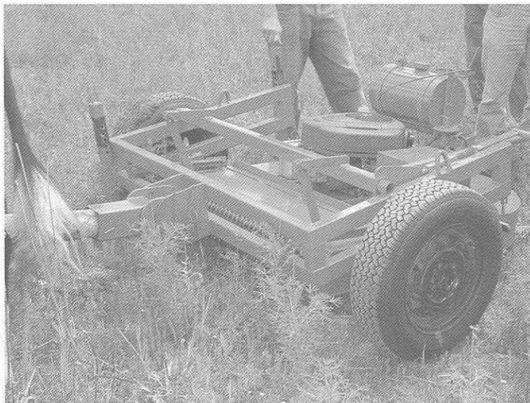
Figura 9. Desbrozadora rotativa con motor y traccionada por bueyes
