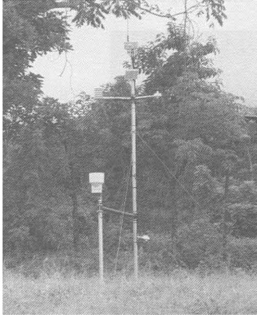
Estación instalada por el CODEPAP en San Andrés Tuxtla en el módulo de riego Laguna Encantada y forma parte de la red de monitoreo agrometeorológico y del suelo.
