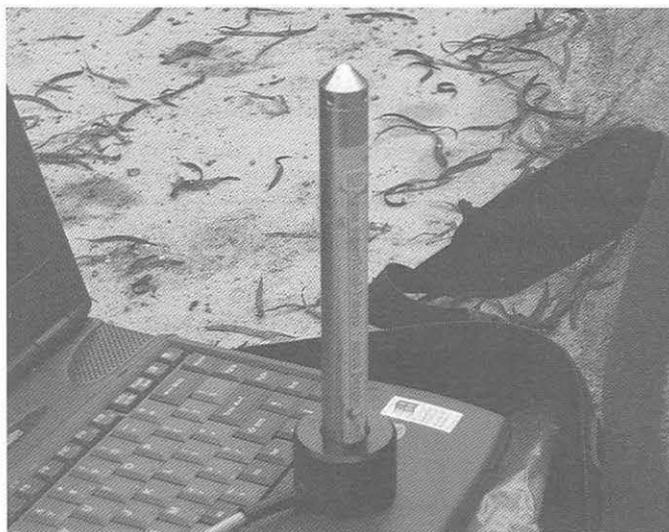
Figura 5. Sensor de presión (DIVER) conectado a un computador para extraer la información.
